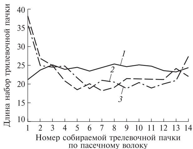
Рис. 2. Среднее значение длин набора трелевочных пачек по пазечным волокам: ряды для лесосек: 1 — с равномерным распределением деревьев; 2 — с куртинным расположением деревьев при первом разыгрывании; 3 — с куртинным расположением деревьев при втором разыгрывании
