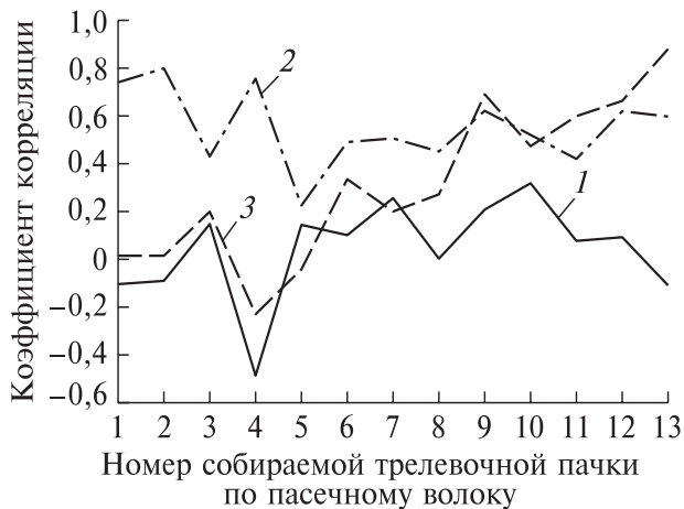
Рис. 4. Коэффициент корреляции смежных значений длин набора пачек по пасечным волокам: ряды для лесосек: 1 — с равномерным распределением деревьев; 2 — с кучинным расположением деревьев при первом разыгрывании; 3 — с кучинным расположением деревьев при втором разыгрывании
