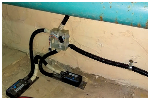
Рис. 4. Тензодатчики в конструкциях: а — высотный комплекс «Континенталь» в Москве; б — башня Бурдж-Халифа в Дубае (ОАЭ)
