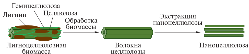
Рис. 3. Схема получения наноцеллюлозы из биомассы Fig. 3. Scheme for the production of nanocellulose from biomass
