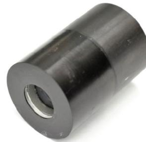
**Рис. 4.** Фотоприемный модуль на основе фотокатода GaAlN
