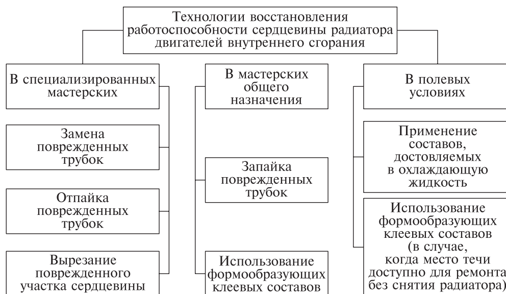
Рис. 1. Технологии восстановления работоспособности сердцевины радиатора Fig. 1. Technologies for restoring performance of the radiator core
