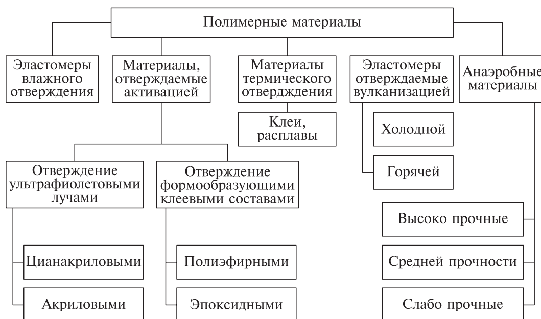
Рис. 2. Классификация полимерных материалов, используемых при ремонте техники Fig. 2. Classification of polymer materials used in the repair of equipment
