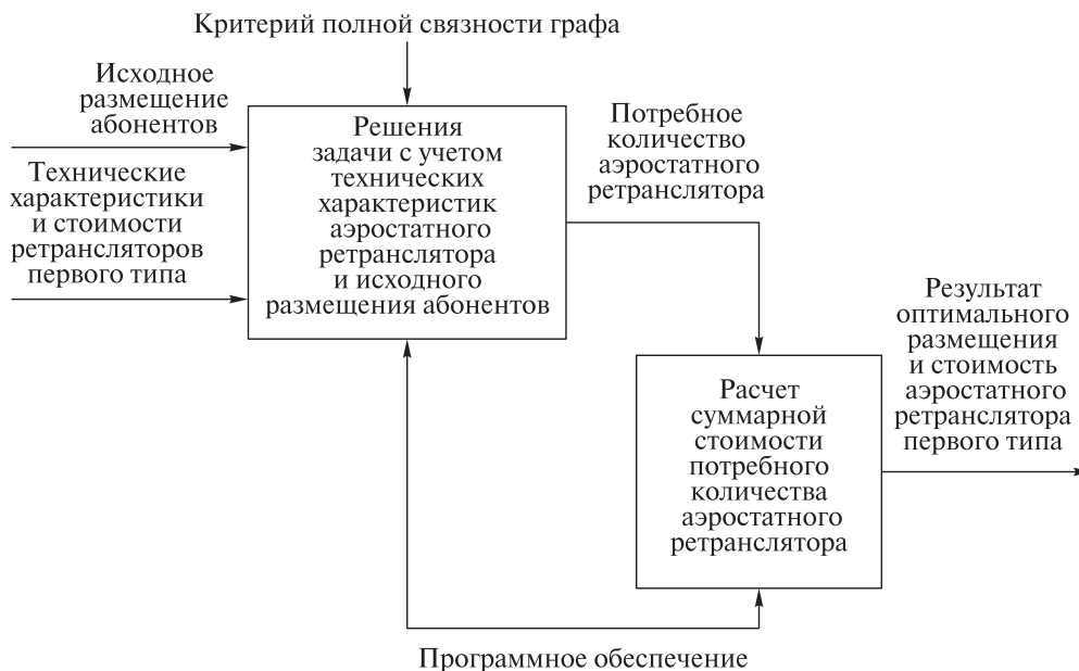
Рис. 3. Расчет оптимального размещения аэростатных ретрансляторов первого типа Fig. 3. Calculation of the optimal placement of the balloon type repeaters of the first type
