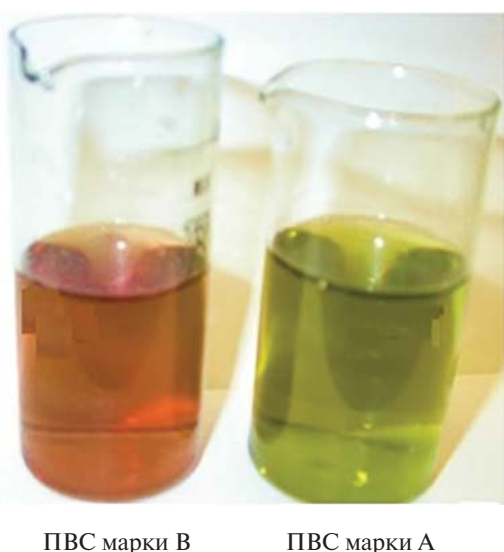
Рис. 2. Внешний вид растворов на основе ПВС образцов-аналогов после качественной реакции с йодом Fig. 2. Appearance of solutions based on PVAL of samples-analogues after qualitative reaction with iodine
