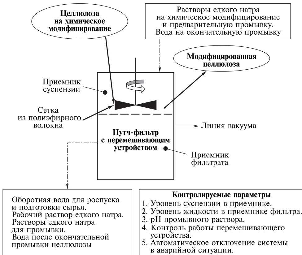
Рис. 2. Конструкция и блок-схема работы нутч-фильтра Fig. 2. Design and block diagram of the operation of the Nutsche filter
