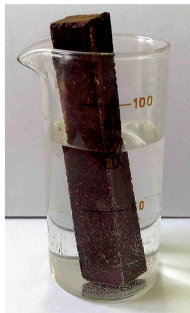
Рис. 6. Лигнопластик из пресс-массы с «бурой гнилью» Fig. 6. Lignoplastic from a press-mass with «brown rot»
