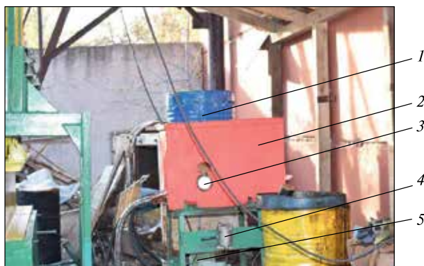
Рис. 3. Система циркуляции антисептика: 1 — емкость для холодного антисептика (холодная ванна); 2 — емкость для горячего антисептика (горячая ванна) со встроенными теплоэлектронагревателями (ТЭНами); 3 — термометр; 4 — фильтр грубой очистки системы циркуляции антисептика ЖТК; 5 — насосный агрегат системы циркуляции маслянистого антисептика ЖТК
