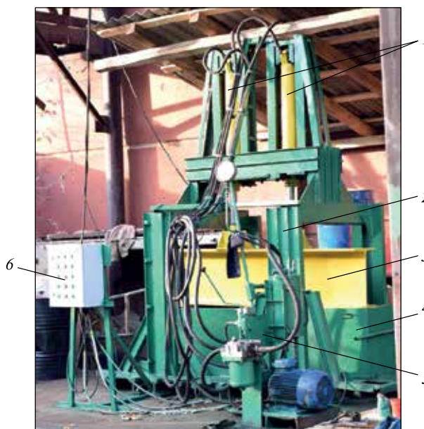
Рис. 2. Общий вид опытной установки СПК-1М: 1 — гидроцилиндры (2 шт.); 2 — силовая рама; 3 — пуансон (нажимная плита); 4 — рабочая ванна; 5 — гидростанция; 6 — шкаф управления
