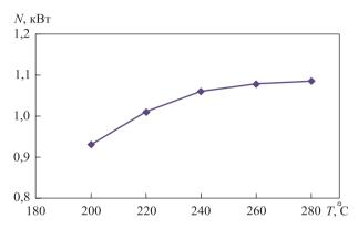
**Рис. 3.** Зависимость мощности двигателя от температуры торрефикации топлива из биомассы
