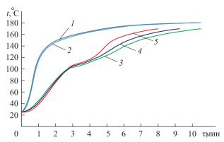
Рис. Изменение температуры в брикете в процессе прессования при различных значениях плотности брикета: I — температура на нижней поверхности брикета; 2 — температура на верхней поверхности брикета; 3-5 — температура в центре брикета (3 —  $\rho_{\rm бp}$  = 310 кг/м $^3$ ; 4 —  $\rho_{\rm бp}$  = 660 кг/м $^3$ ; 5 —  $\rho_{\rm бp}$  = 1100 кг/м $^3$ )
