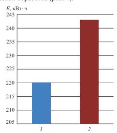
**Рис. 4.** Сравнительные характеристики выработки электроэнергии из различных источников: I — растительное сырье; 2 — торрефицированное растительное сырье
