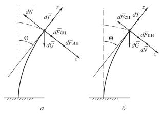
**Рис. 1.** К расчету сил, действующих на частицу препарата: a — верхнее расположение;  $\tilde{o}$  — нижнее расположение **Fig. 1.** The calculation of forces acting on a particle of the drug: a — top location; b — bottom location
