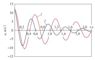
Рис. 3. График изменения ускорения березы (аппроксимированные кривые): I — ствол № 1; 2 — ствол № 2
