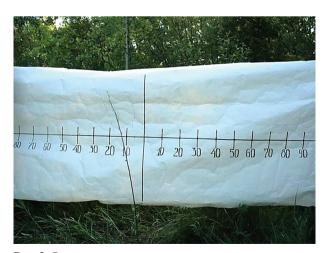
**Рис. 2.** Определение отклонения стволика **Fig. 2.** Determination of the deflection of the tree trunk
