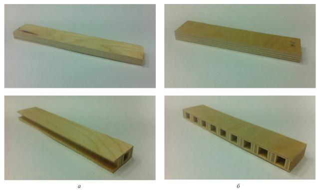
**Рис. 2.** Внешний вид образцов для определения предела прочности при изгибе: a — вдоль волокон;  $\delta$  — поперек волокон **Fig. 2.** Appearance of the samples for determining the flexural strength: a — along the fibers;  $\delta$  — across the fibers
