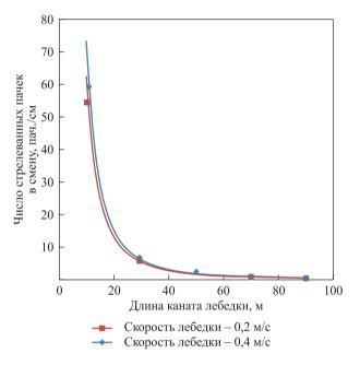
**Рис. 3.** Зависимость числа стрелеванных пачек в смену от длины тягового каната лебедки (1 вальщик, 1 лебедка, объем отпада =  $20 \text{ m}^3$ /га)
