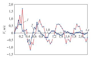
Рис. 2. Зависимость изменений скорости колебаний березы от времени (экспериментальные кривые): I — ствол № 1; 2 — ствол № 2
