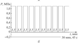
**Рис. 2.** Циклограммы аэрозольной пропитки березовых брусков: a — бруски без видимых пороков;  $\delta$  — с сучками до 20 % объема бруска или имеющие косослой [10, 11]
