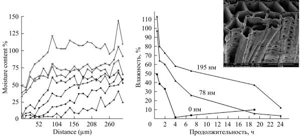
**Рис. 2.** Распределение влажности по толщине соснового образца при низкотемпературной сушке (слева), кривые изменения влажности на различной глубине и микрофотография поверхности образца (справа)
