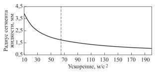
**Рис. 8.** Зависимость радиуса сегмента жидкости от ускорения
