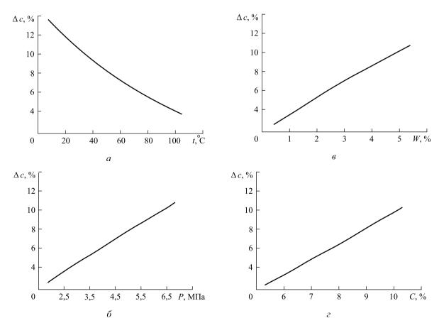
**Рис. 5.** Зависимость содержания смазки в древесине  $\Delta c$ , %, от различный факторов: a — температуры t, °C;  $\delta$  — давления P, МПа;  $\epsilon$  — влажности W, %;  $\epsilon$  — содержания модификатора в древесине C, %.
