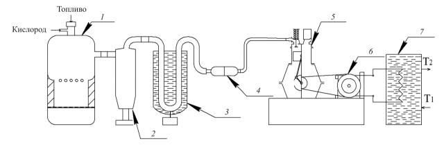
**Рис. 1.** Технологический комплекс для выработки электрической энергии: 1 — газогенератор; 2 — циклон для охлаждения газа; 3 — змеевиковый теплообменник; 4 — фильтр; 5 — двигатель внутреннего сгорания; 6 — электрогенератор; 7 — теплообменник
