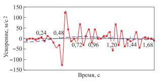
**Рис. 6.** График изменения ускорения вершины березы с листьями ( $d_0 = 14$  мм, H = 1,75 м)
