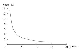
Рис. 1. Зависимость максимальной длины конденсаторной пластины от частоты тока при неравномерности распределения напряженности поля вдоль конденсатора не выше 10 %
