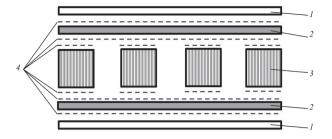
**Рис. 1.** Конструкция фанеры: *1* — продольные слои шпона; *2* — поперечные слои шпона; *3* — рейки, поставленные на ребро; *4* — клеевые швы
