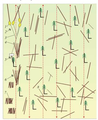
Рис. 2. Уборка захламленности леса: *1* — конусы; *2* — вальщик; *3* — тяговый канат; *4* — пачки стрелеванных деревьев отпада; *5* — лебедчик; *6* — вальщик-раскряжевщик; *7* — поленницы из раскряжеванных деревьев отпада
