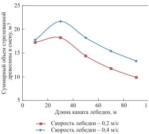
Рис. 4. Зависимость объема стрелеванной древесины в смену от длины тягового каната лебедки (1 вальщик, 1 лебедка, объем отпада =  $20 \text{ m}^3/\text{гa}$ )
