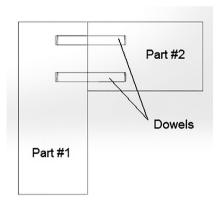
Fig.1. End to edge butt joint **Рис. 1.** Соединение торцевого стыка
