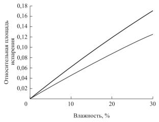
Puc. 4. Зависимость относительной площади испарения с поверхности древесины сосны и дуба от влажности
