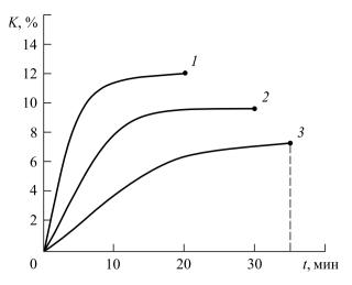
Рис. 4. Содержание масла в брусках после пропитки: 1 — бруски без пороков; 2 — бруски с сучками до 20 % объема; 3 — бруски с косослоем
