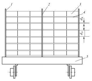
Рис. 3. Трехэлектродный рабочий конденсатор с вертикальными электродами: 1 — центральный (высокопотенциальный) электрод; 2 — боковой электрод; 3 — пиломатериалы; 4 — прокладки толщиной 2,5 см; 5 — тележка
