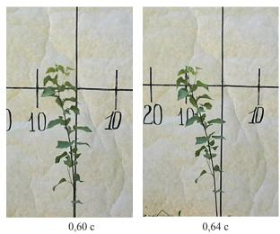
**Рис. 3.** Отклонение березы с листьями в первый полупериод колебаний за 0,04 с ( $d_0=4$  мм, H=0,52 м)
