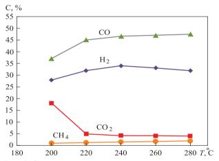
Puc. 2. Состав генераторного газа, полученного при газификации торрефицированного топлива из биомассы
