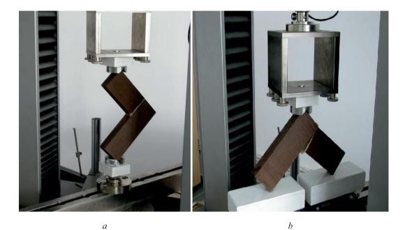
**Fig. 2.** Testing of end to edge butt joint at compression (*a*) and tensile (*b*) **Puc. 2.** Испытание концевого стыкового стыка при сжатии (*a*) и растяжение (*b*)
