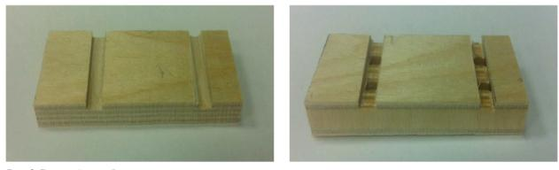
**Рис. 3.** Внешний вид образцов для определения предела прочности при скалывании по клеевому слою **Fig. 3.** Appearance of the samples for determining the ultimate strength at shearing along the adhesive layer
