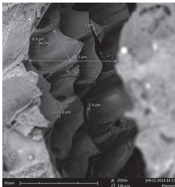
Рис. 4. Электронная микрофотография лигнифицированных трахеид древесины ели, пораженной грибами бурой гнили (увеличение 2000 × )
