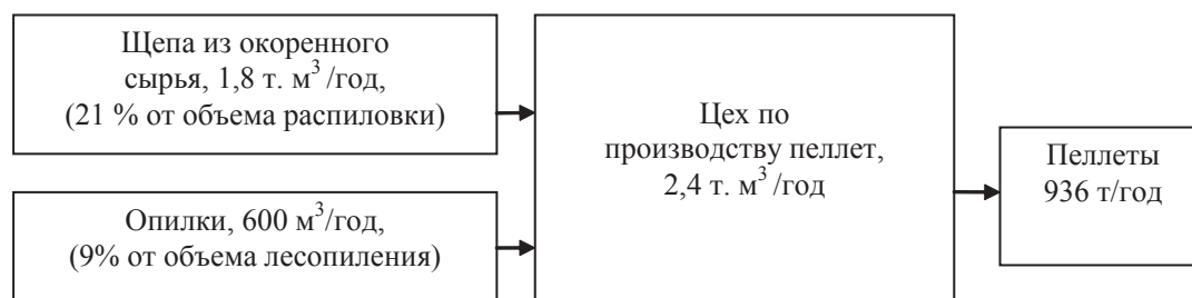
Рис. 3. Материальный баланс сырья производства пеллет при существующем технологическом процессе Fig. 3. The material balance of raw for pellet production at the existing technological process
