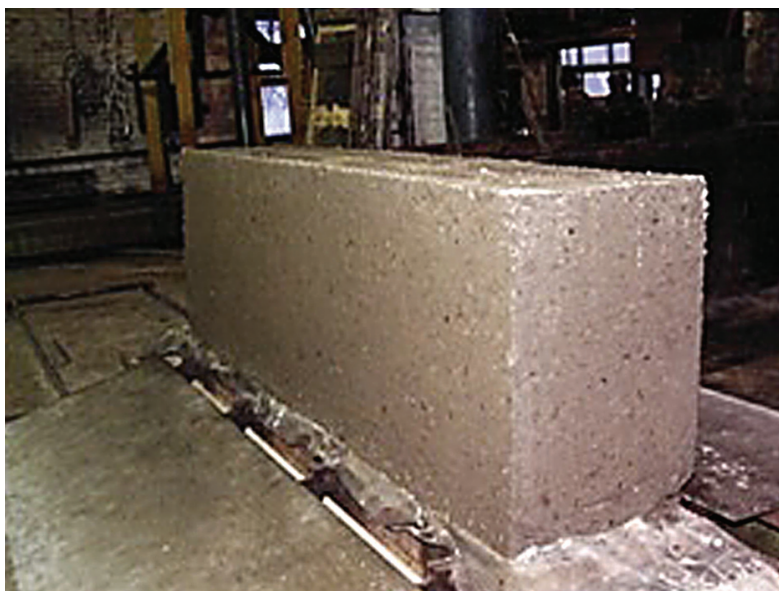
Рис. 3. Освобождение блоков из пресс-форм Fig. 3. The release of the blocks from the molds
