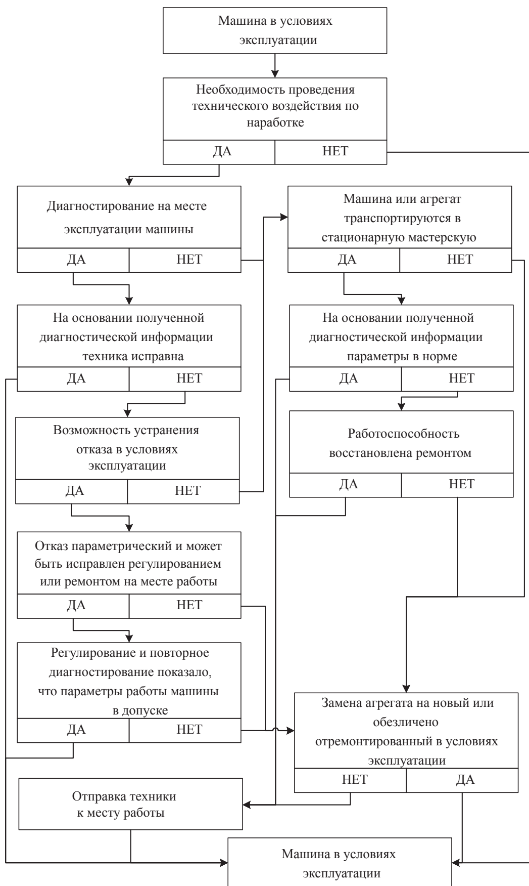
Рисунок. Алгоритм управления техническим состоянием машин лесопромышленного комплекса Figure. Algorithm control the technical condition of the timber industry machines
