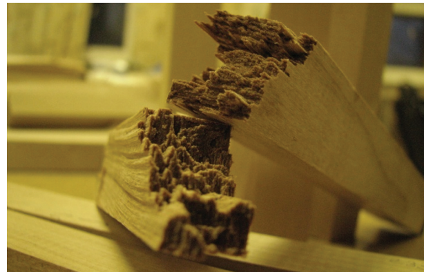
Рис. 4. Поперечное разрушение образцов Fig. 4. Cross the destruction of samples
