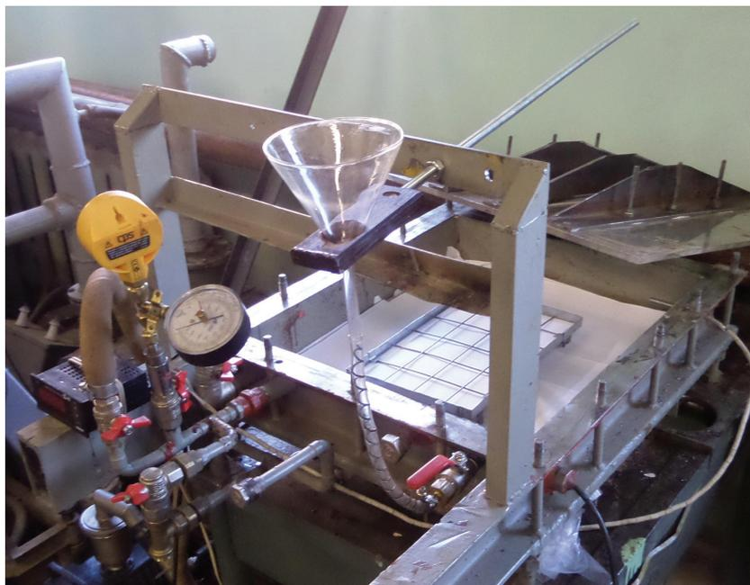
Рис. 1. Стенд для вакуумной пропитки
