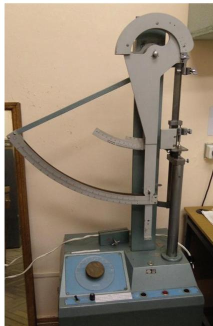
Рис. 2. Разрывная машина МРБ-100
