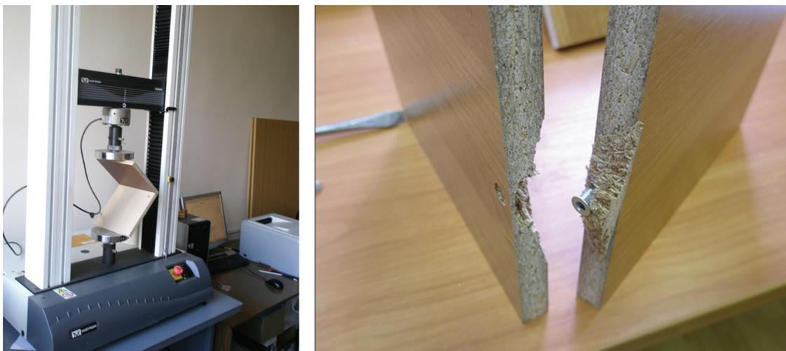
Рис. 7. Образец, закрепленный в испытательной машине, и характер разрушения углового соединения
