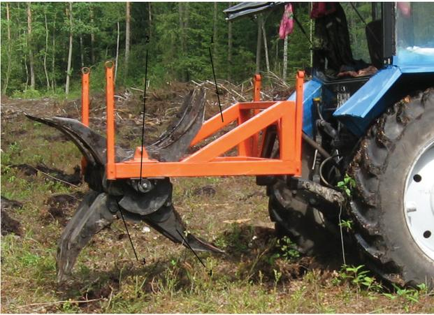
Рис. 2. Орудие для дискретной обработки почвы ОДП-0,6
