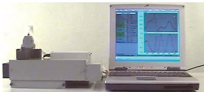
Рис. 2. Адаптивный идентификатор – 35-канальный спектроэллисометр для использования в лабораторных условиях или в полевых условиях путем взятия образца жидкости
