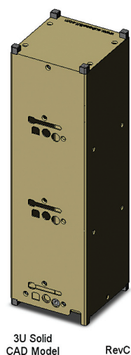
Рис. 4. Монолитный тип корпуса КА Fig. 4. Monolithic type of spacecraft housing
