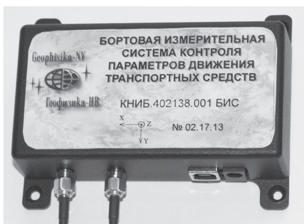
Рис. 5. Фотография бортовой измерительной системы контроля параметров движения транспортного средства
