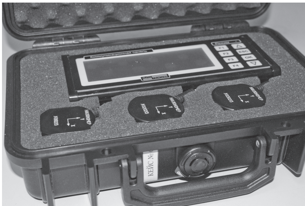
Рис. 3. Фотография комплекта системы измерения веса груза в таре для установки на транспортное средство Fig. 3. A photo of a set of cargo weight measuring in containers to be mounted on a vehicle
