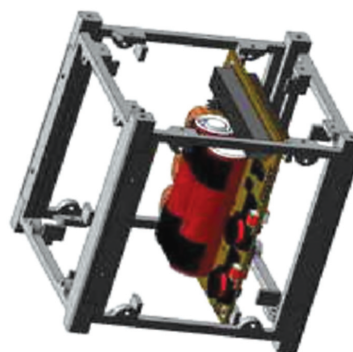
Рис. 5. Реечный тип корпуса КА Fig. 5. Rack Enclosure type of spacecraft housing
