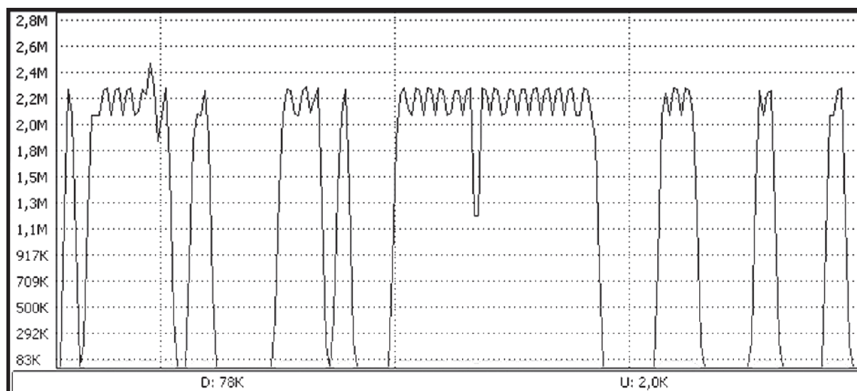
Рис. 6. Экспериментально полученные данные при передаче большого файла 100 Мб Интернет. Fig. 6. The experimental data for transferring a large 100 MB file through the Internet
