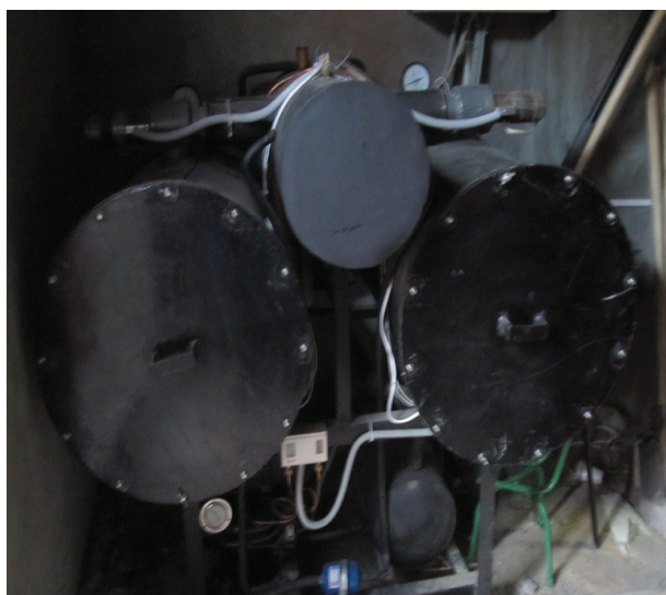
Рис. 5. Пилотная вакуум-осциллирующая установка с тепловым насосом
