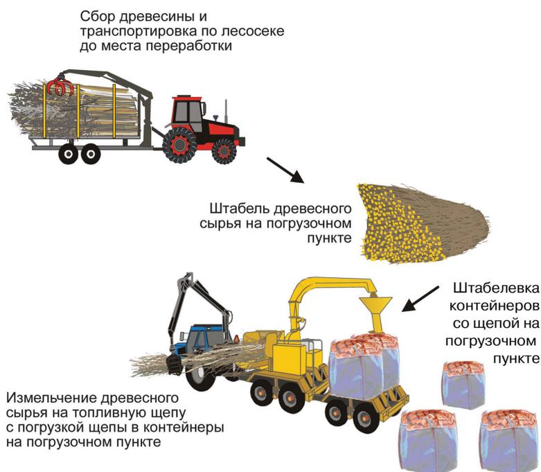
Рис. 5. Работа рубительной машины с заполнением контейнеров щепой и укладкой их на погрузочном пункте
