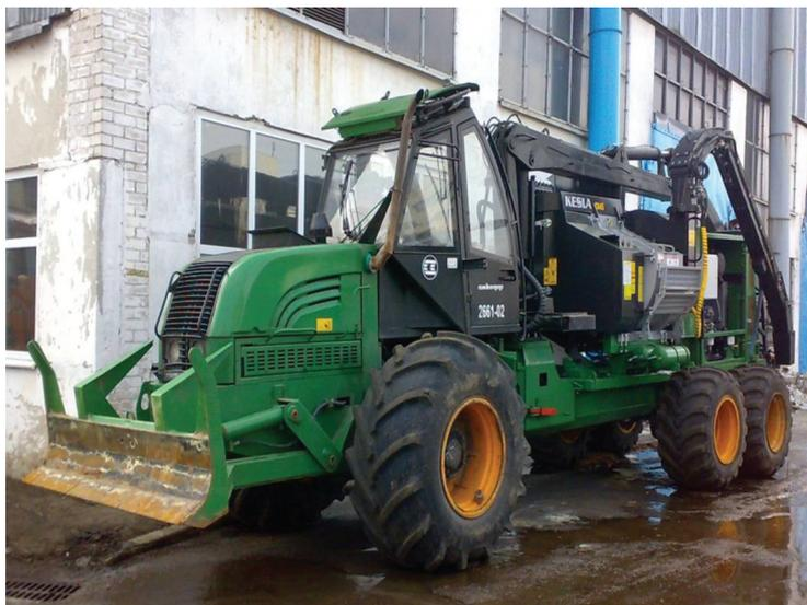
Рис. 1. Рубильная машина на мобильном шасси
