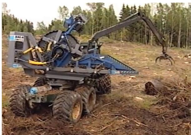
Рис. 6. Пресс *Flexus Tornado*, установленный на форвардере для прессования и обвязки лесосечных отходов в тюки цилиндрической формы (фото *Flexus Balasystem AB*)
