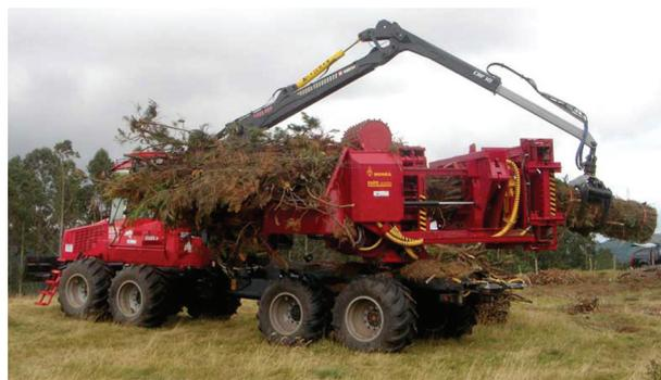
Рис. 2. Пакетирующая установка *ENFO 2000* на базе форвардера *Valmet-860.3* (фото *Monra Forestal*)
