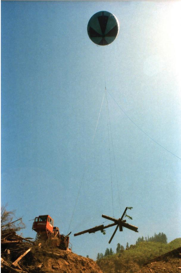
Рис. 1. Аэростатно-канатная система для транспортировки древесины
