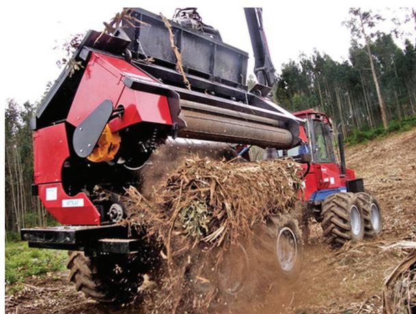
Рис. 4. Пакетирующий модуль *WoodPac* на базе форвардера *Valmet* (фото «Komatsu forest»)
