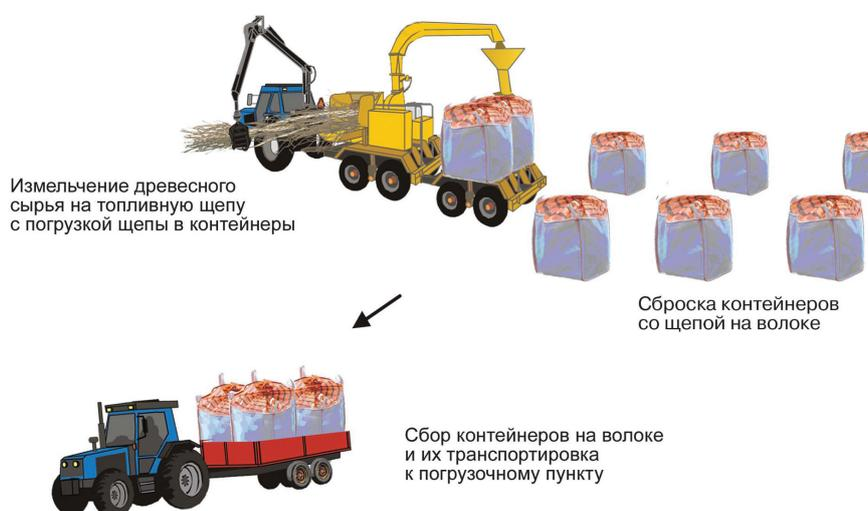
Рис. 3. Работа мобильной рубительной машины со сброской контейнеров на лесосеке
