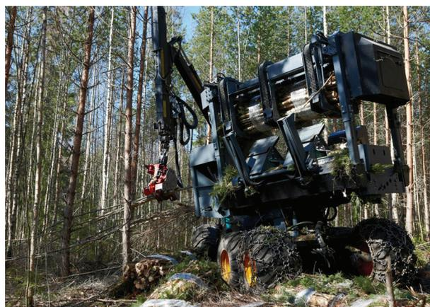
Рис. 7. Формирование пакета топливной древесины пресс-пакетировщиком *Fixteri FX-15a* (фото *Fixteri Oy*) [10]
