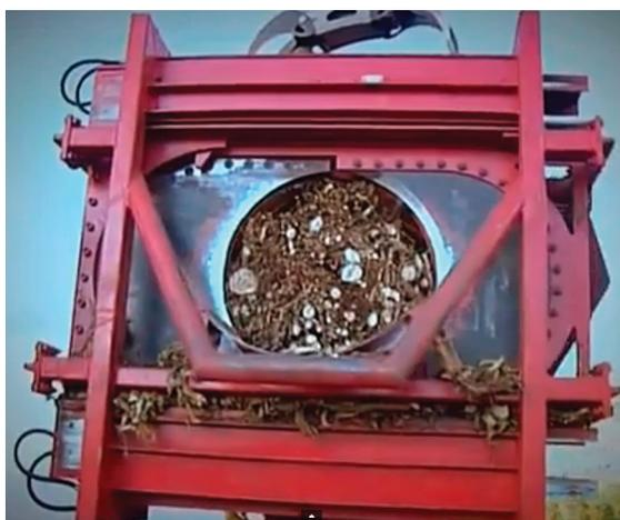
Рис. 3. Режущий механизм гильотинного типа пакетирующей установки *ENFO 2000* (фото *Monra Forestal*)
