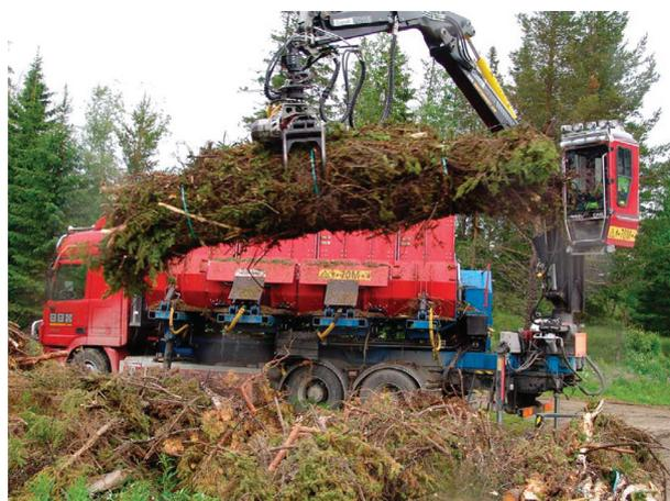
Рис. 5. Пакетирование лесосечных отходов *Rogbico GTK 5100* на придорожном складе (фото *Rogbico AB*)
