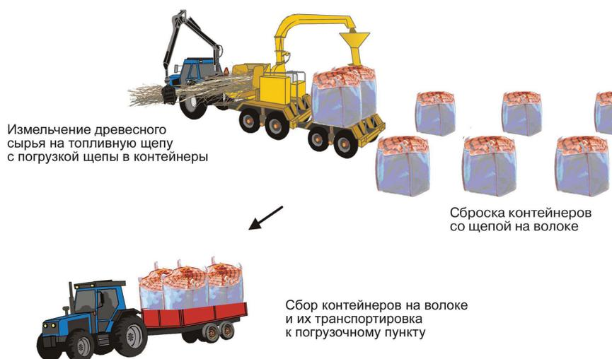
Рис. 2. Работа мобильной рубительной машины со сбросом контейнеров на лесосеке
