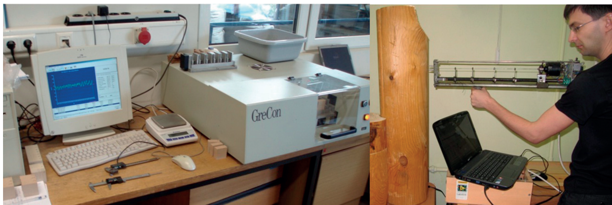
Рис. 1. Лабораторная установка DA-X для контроля объемной плотности древесины и древесных материалов, каф. технологии деревообработки и древесных композиционных материалов, университет Георга-Августа, Германия (Abteilung Holztechnologie und Holzwerkstoffe, Georg-August-Universität Göttingen) (слева); устройство для измерения сопротивления просверливанию (мобильное устройство для диагностики состояния древесины), каф. деревообрабатывающих производств ПГТУ (справа)
