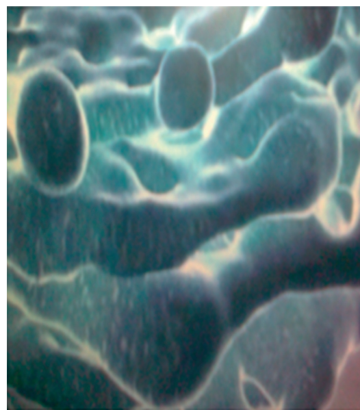
Рис. 4. Каналы на поверхности шунгита с порами на поверхности шунгита (увеличение в 56 000 раз) (увеличение в 75 000 раз)
