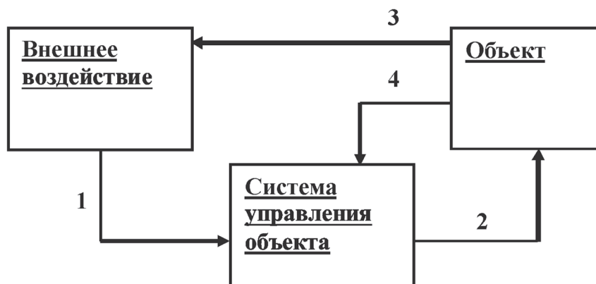
Рис. 2. Схема взаимодействия внешнего воздействия и объекта: 1 – внешнее воздействие; 2 – передача СУ (системой управления объекта) внешнего воздействия на объект; 3 – отклик объекта (воздействие) на внешнюю среду ( линейный отклик ); 4 – отклик объекта (воздействие) на свою СУ в результате внешнего воздействия ( нелинейный отклик )
