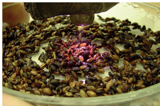
Рисунок. Обработка семян сосны обыкновенной холодным плазменным спреем
