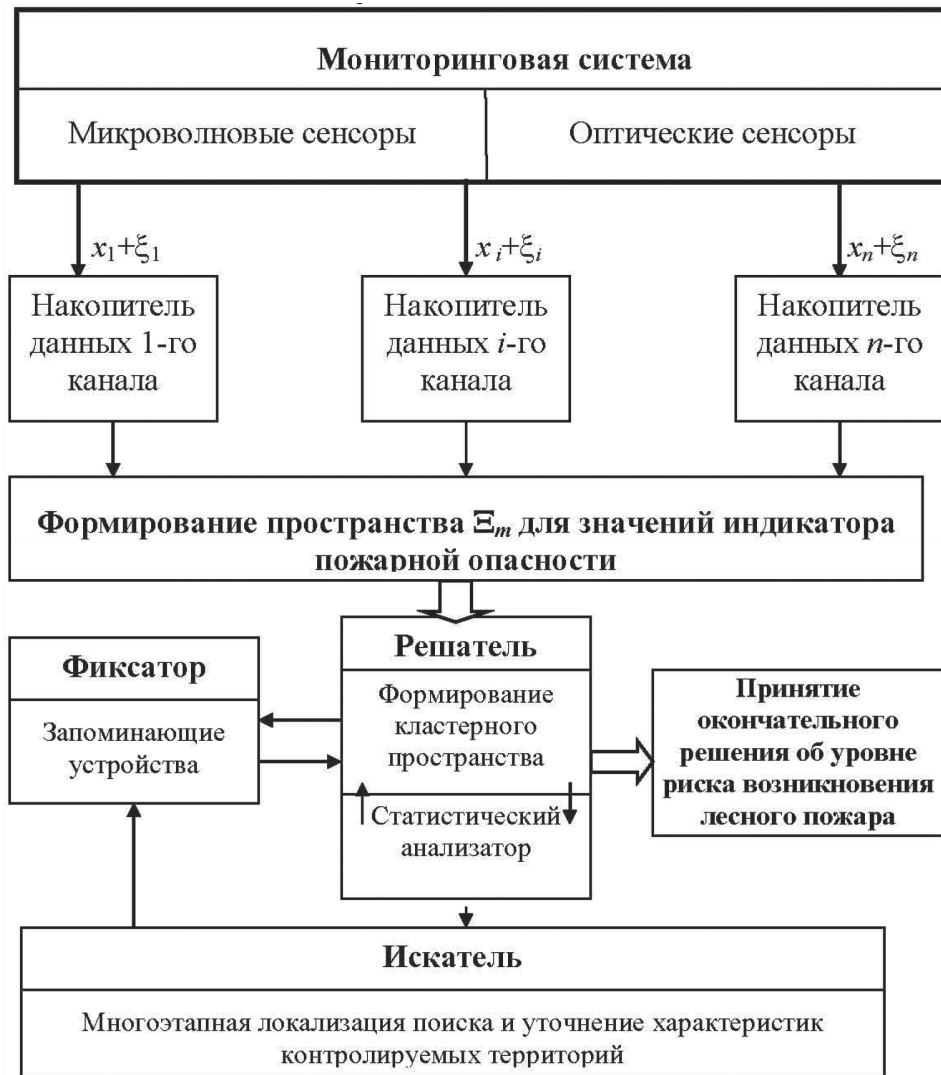
Рис. 7. Структурная схема мониторинговой системы поиска и обнаружения зон возможного загорания в лесу
