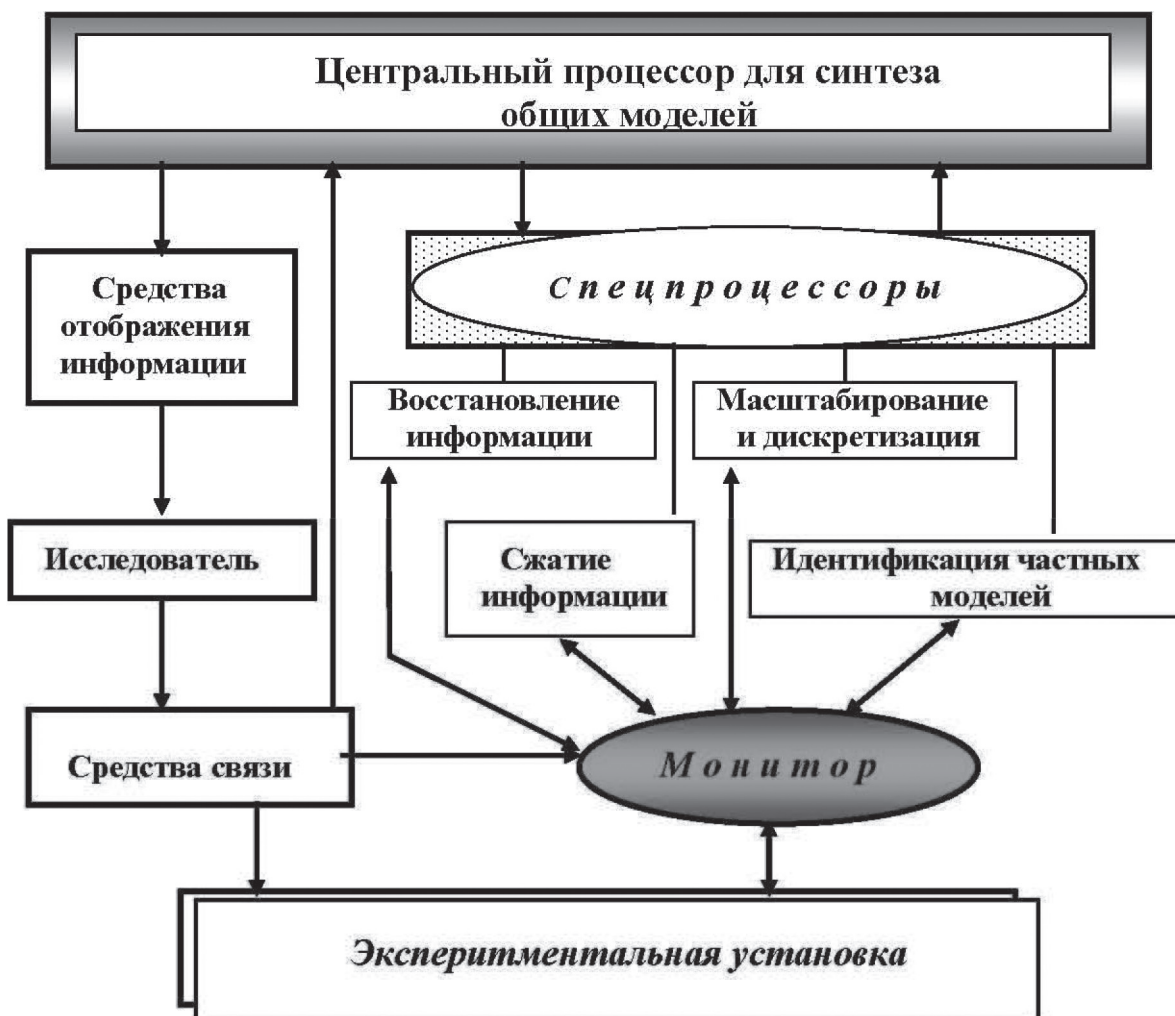
Рис. 3. Принципиальная структура системы автоматизации научных исследований с использованием устройств типа предсказывающих и распознающих процессоров
