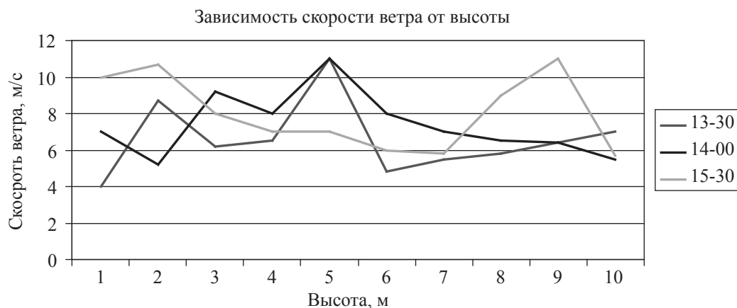
Рис. 2. Профили скорости ветра, измеренные ИКГЛ
