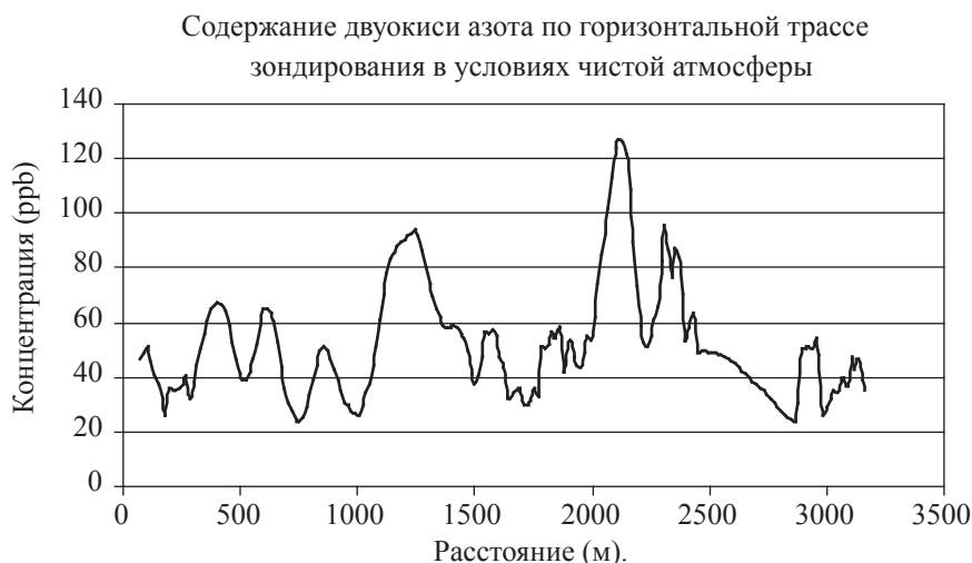
Рис. 4б. Распределение концентрации \text{NO}_2 по трассе зондирования, получено на мобильном лидаре
