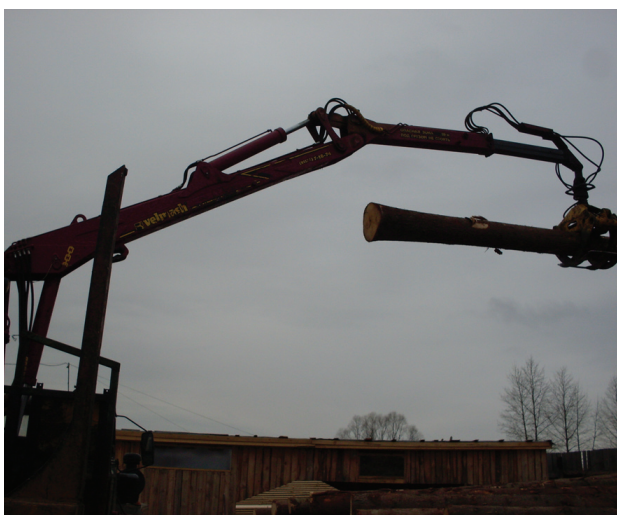
Рис. 4. Отпускание стрелы манипулятора при максимальном вылете с нагрузкой
