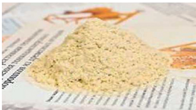
Рис. 5. Древесная мука, полученная в аппарате с 20 пульсационными камерами
