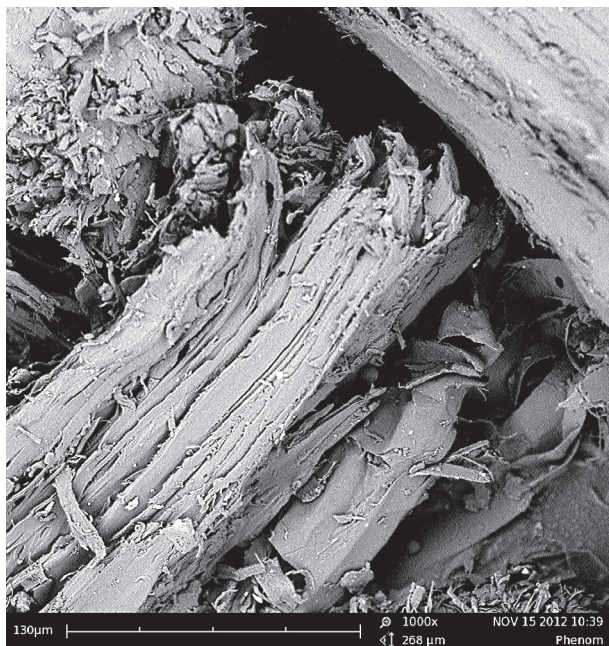
Рис. 3. Электронная микрофотография древесной муки полученной на мельнице-нагревателе с 20 пульсационными камерами (увеличение 1000 * )
