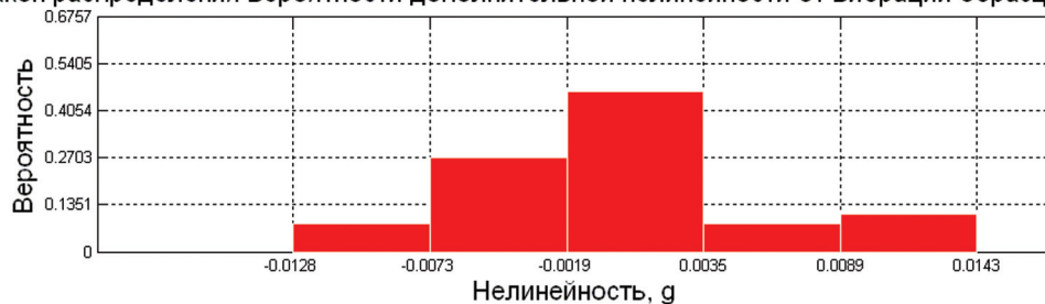
Рис. 4. Виды ЗРВ нелинейностей параметров образца МПЛУ №963 ( m – оценка математического ожидания, \sigma – СКО, d – диапазон ЗРВ, h – шаг ЗРВ; размерность всех этих величин – g )
