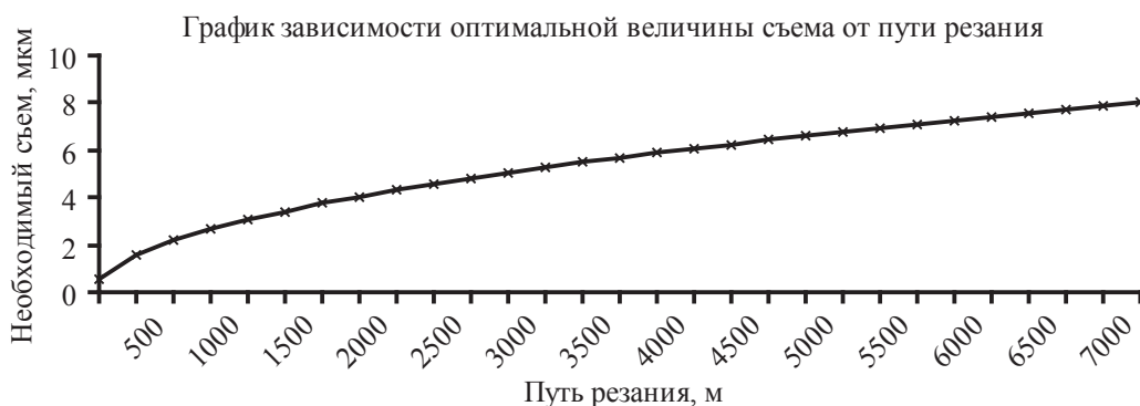
Рис. 4. График зависимости оптимальной величины съема от пути резания
