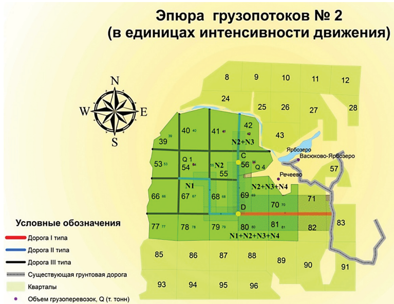
Рис. 3. Установление категории лесной автодороги в зависимости от грузооборота
