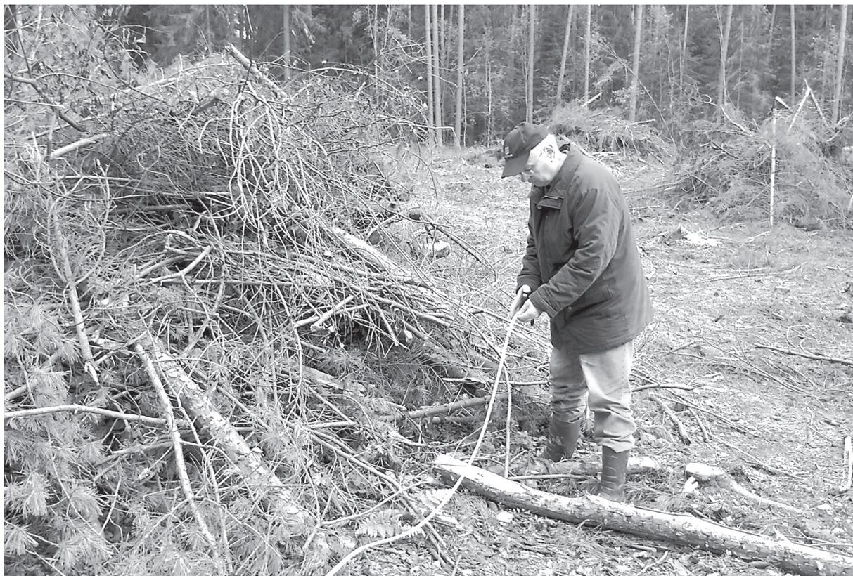
Рис. 5. Измерение периметра скопления лесосечных отходов методом хорд
