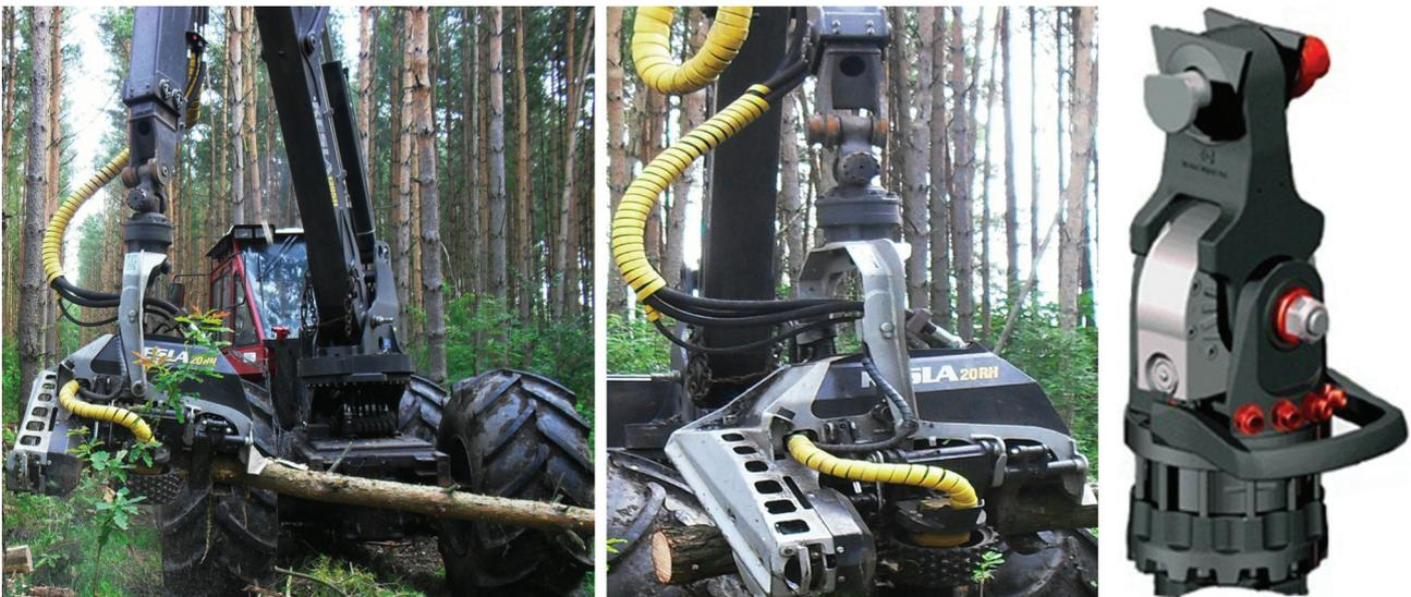
Рис. 3. Гасители колебаний харвестерной головки
