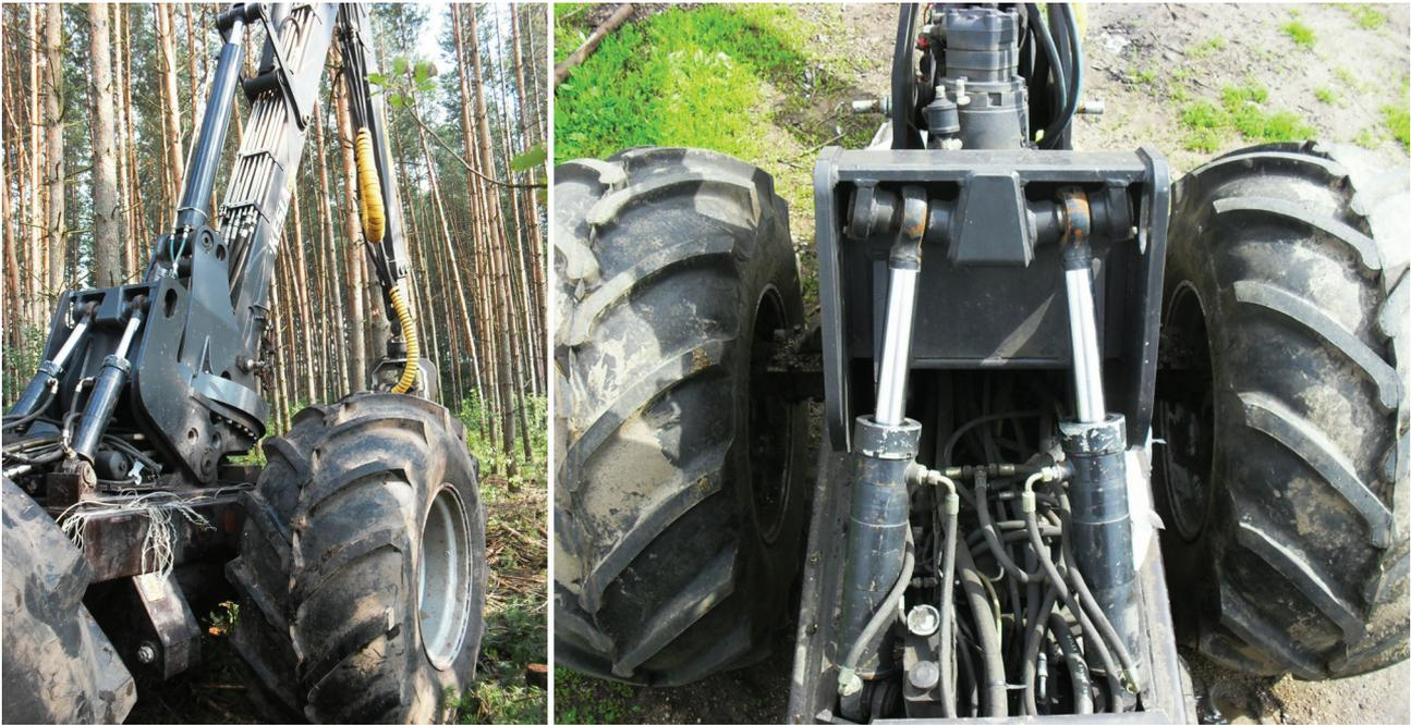
Рис. 2. Общий вид опорно-поворотной платформы манипулятора
