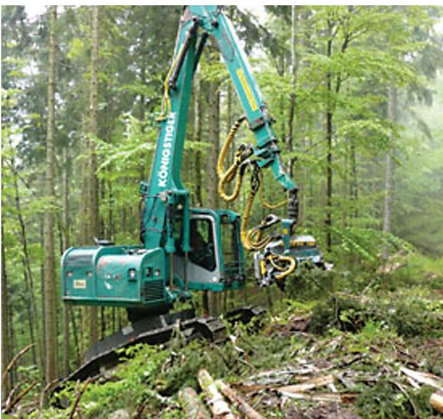
Рис. 4. Харвестер с высокой силой тяги
