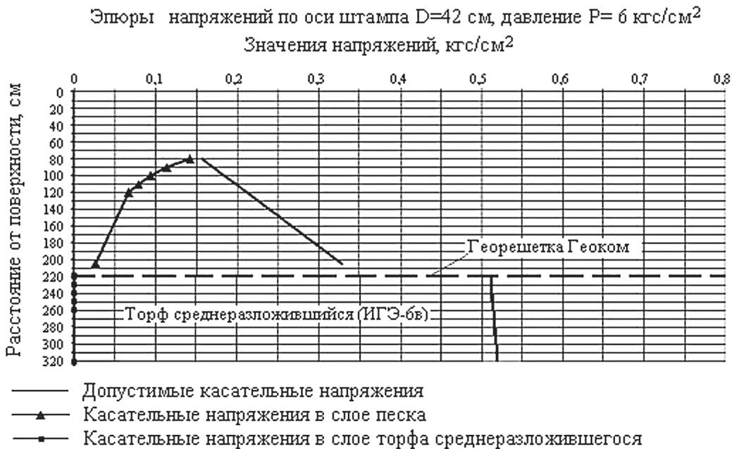
Рис. 6. Эпюры действующих и допускаемых активных касательных напряжений ( $\tau_{акт}$ ) в слабосвязном слое дорожной одежды и подстилающем грунте
