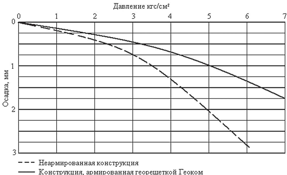
Рис. 3. Сравнительные графики несущей способности конструкций
