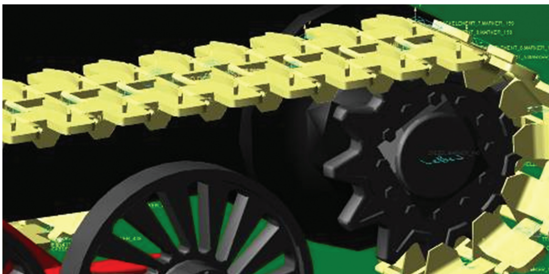
Рис. 3. Гусеничный механизм в ADAMS / View environment. Ведущее зубчатое колесо и траки с сегментами, созданные в SolidWorks и импортированные в MSC ADAMS/View, трак на рисунке свободно оборачивается вокруг колеса
