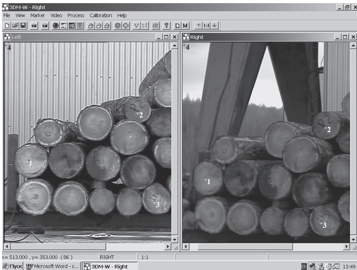
Рис. 4. Определение плоскости трансформирования тремя точками
