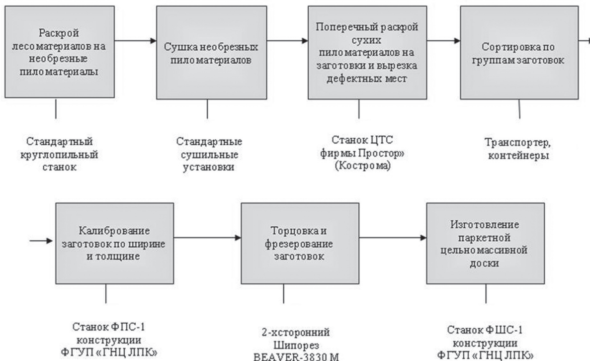
Рис. 4. Технологическая схема производства цельномассивной доски пола из низкосортной древесины
