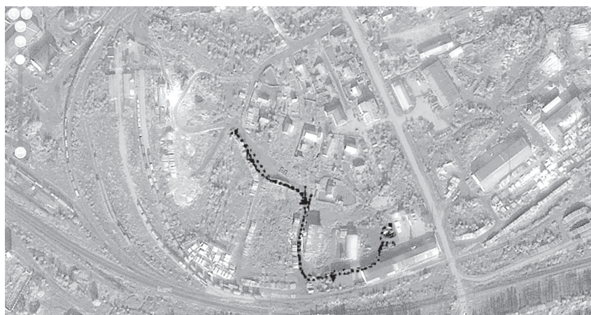
Рис. 5. Траектория движения лесозаготовительной машины на навигационной карте, полученная с помощью программы система учета и системы ГЛОНАСС
