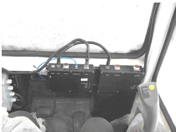
Рис. 3. Регистратор и блок сбора данных системы СНМП-ЛЗ с соединительными жгутами, установленные в кабине машины ЛЗ-5
