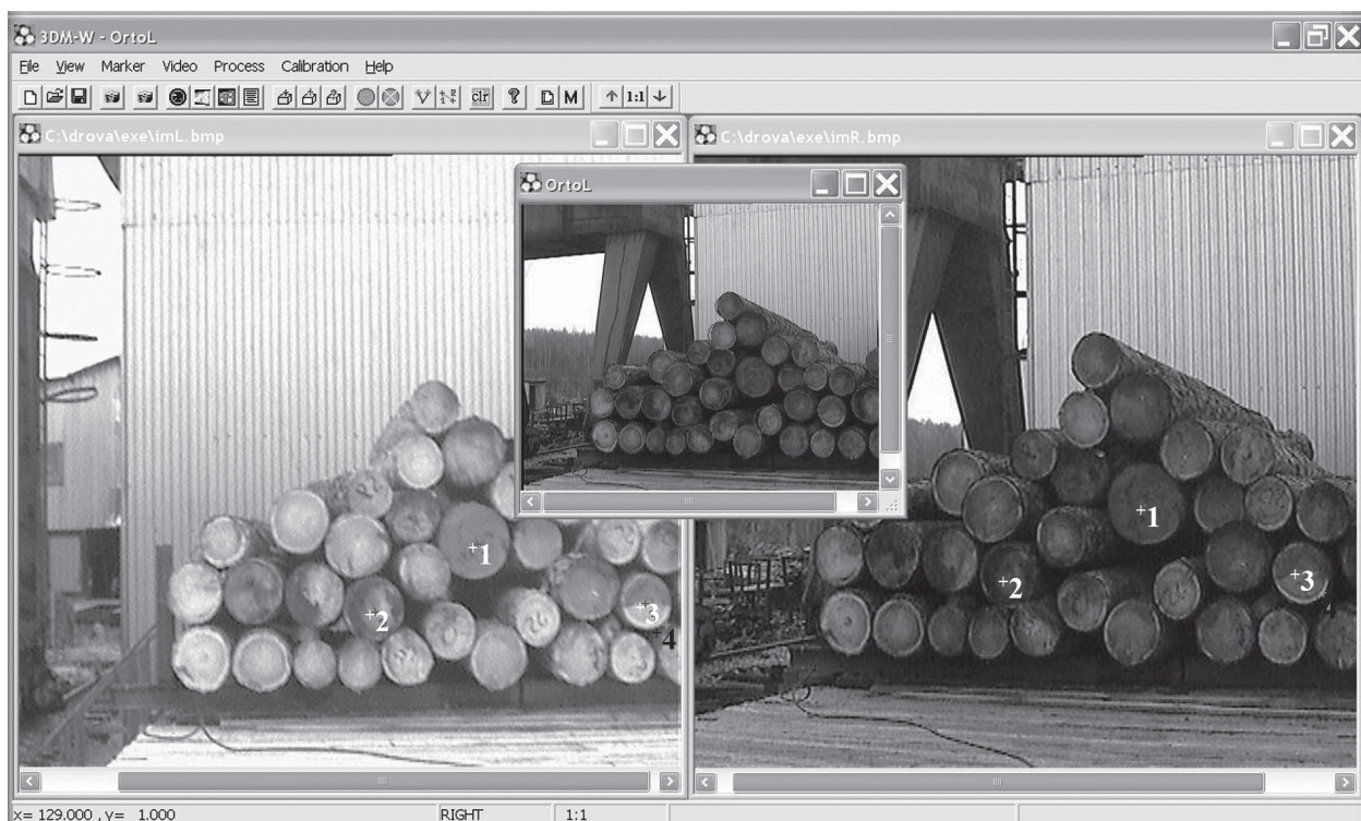
Рис. 5. Расчет ортофото и распознавание спилов
