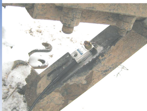
Рис. 4. Тензорезисторный датчик деформаций производства компании KYOWA (Япония) установлен на опорной балке кузова машины ЛЗ-5
