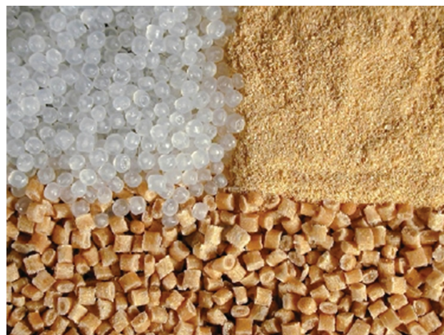
Рис. 2. Смола (полиэтилен), древесная мука, гранулированный древесно-полимерный композиционный материал
