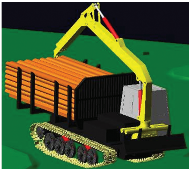
Рис. 7. Гусеничная лесозаготовительная машина с детально проработанной ходовой системой, приводом и рамой. Модель, созданная в SolidWorks и импортированная в MSC ADAMS / View
