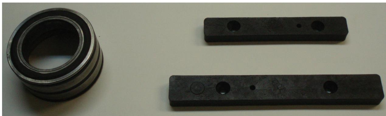
Рис. 2. Детали и сборочные единицы крановой установки МТА-160К: а) подшипник INASL 045014 PPSM механизма подъема груза, восстановленный с использованием вкладыша из полиамида, наполненного металлизированными порошками ПГ-УС25; б) направляющие опоры механизма перемещения стрелы, изготовленные с использованием полиамида, наполненного металлизированными порошками ПГ-УС25
