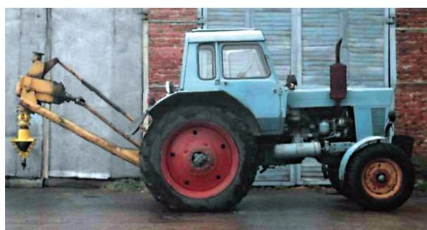
Рис. 1. Общий вид машины, оснащенной конической фрезой с жидкостным наполнителем
