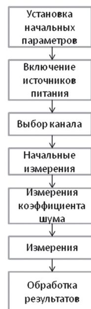
Рис. 3. Алгоритм выполнения программы измерения амплитуды и фазы коэффициента передачи и коэффициента шума
