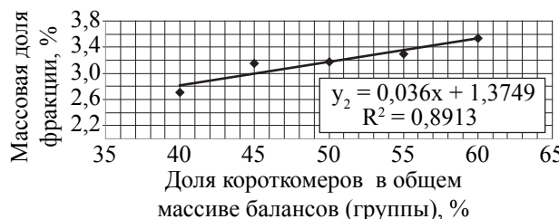
Рис. 5. Доля (средние значения для групп) крупной фракции ( y_2 ) в зависимости от доли короткомеров ( x ) в сырье
