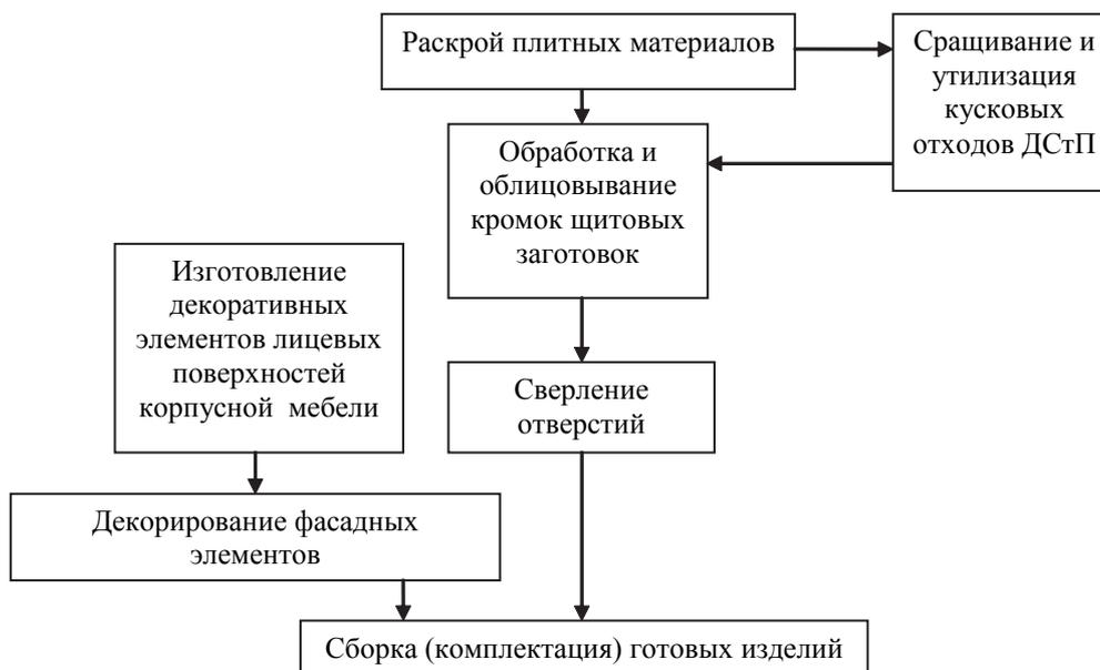
Рис. 1. Схема изготовления изделий корпусной мебели на малых предприятиях
