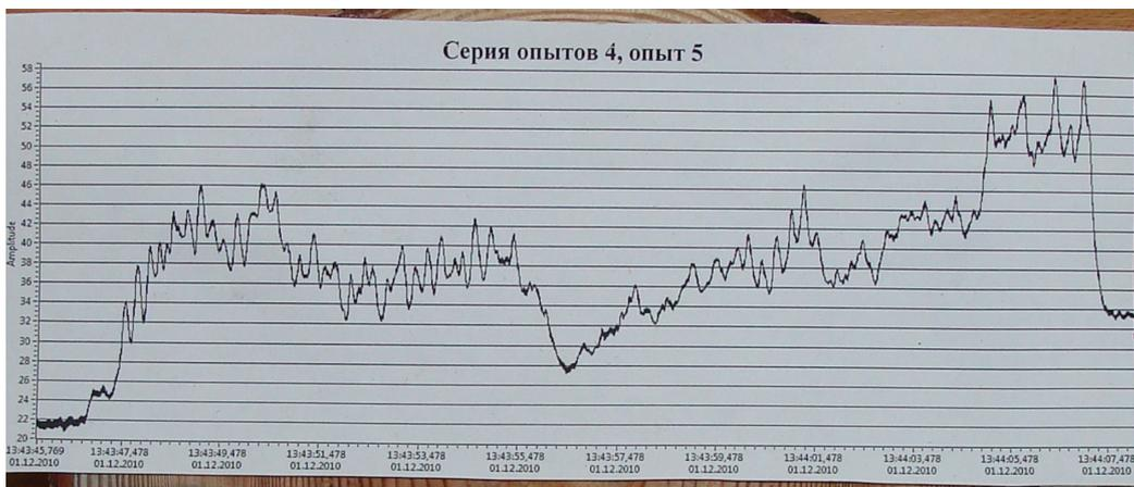
Рис. 6. Диаграмма изменения мощности на сверление по диаметру лесоматериала (сосна с ситовой ядровой гнилью,  $W_{ср}=52,9\%$ ,  $D=210$  мм)
