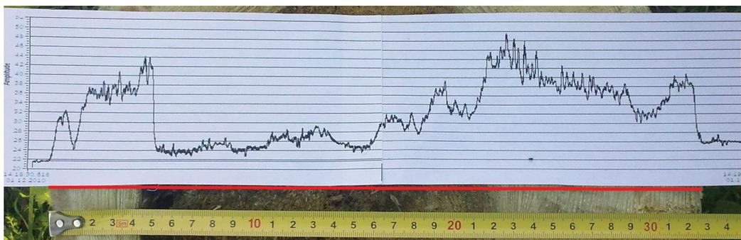
Рис. 5. Диаграмма изменения мощности на сверление по диаметру лесоматериала (ель с ядровой комлевой гнилью,  $W_{ср}=47,6\%$ ,  $D=330$  мм)
