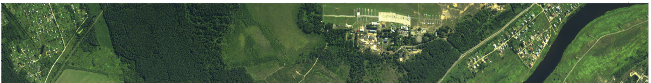
Рис. 2. Синтезированные RGB изображения смежных треков: верхний рисунок – сцена Zmeevo1 (дата/время съемки 2011-08-12/12-27-53), нижний – сцена Zmeevo2 (дата/время съемки 2011-08-12/12-35-44). Крайние кадры указанных сцен совмещены по хорошо заметным антропогенным объектам
