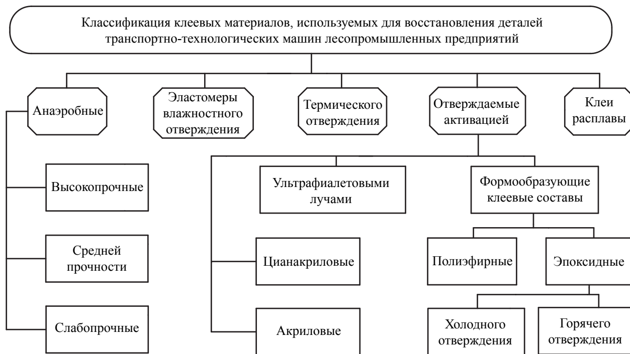
Рис. 1. Классификация клеевых материалов, используемых для восстановления деталей транспортно-технологических машин лесопромышленных предприятий
