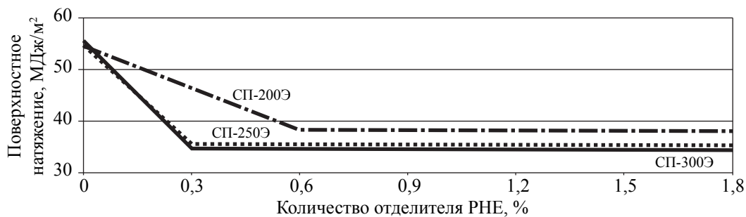
Рис. 2. График зависимости поверхностного натяжения пропиточных олигомеров СП-200Э, СП-250Э, СП-300Э от количества отделителя PHE
