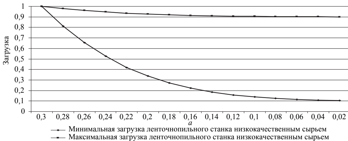
Рис. 3. График загрузки лесопильного оборудования низкокачественным сырьем при сегментно-тангентальной схеме раскроя, для диапазона a \leq 0,3
