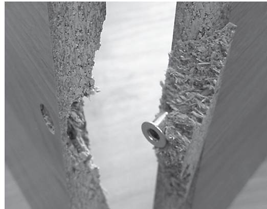
Рис. 3. Угловое соединение на конфирмате после разрушения
