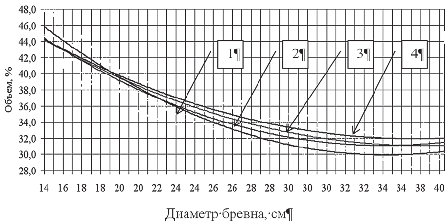
Рис. 7. Изменение объема древесных отходов относительно объема пиловочника (%) при осевой ориентации лесоматериалов перед раскромом, ширине пропилов 2,9 мм от диаметра и длины бревна: 1 – 4,0 м; 2 – 5,5 м; 3 – 6,4 м; 4 – 7,6 м
