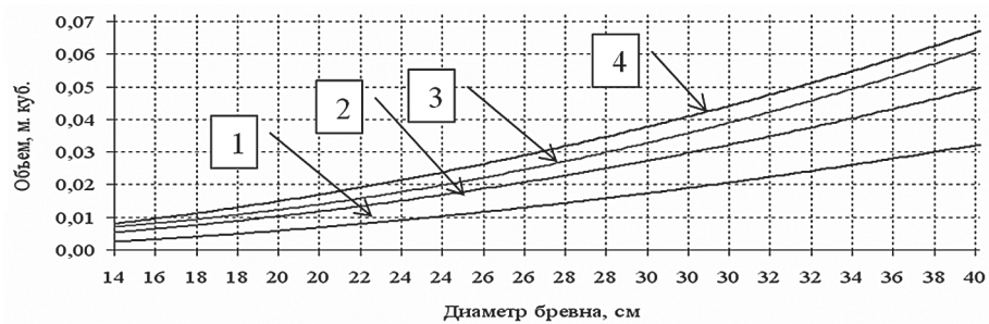
Рис. 4. Зависимость объема рейки ( m^3 ) от вершинного диаметра бревна при его сложной ориентации и ширине пропилов первого и второго проходов 2,5 мм при длине бревна: 1 – 4,0 метра; 2 – 5,5 метра; 3 – 6,4 метра; 4 – 7,6 метра
