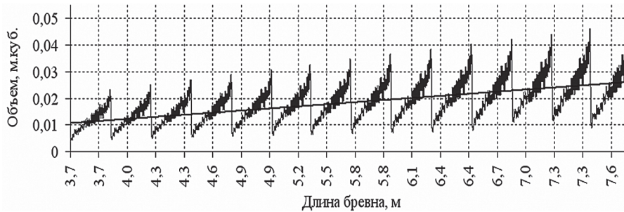
Рис. 7. Зависимость объема опилок ( m^3 ), образующихся при производстве пиломатериалов в процессе переработки лесоматериалов при сложной их ориентации по поставу инструмента лесопильного станка, от диаметра и длины бревна, ширине пропилов первого и второго проходов 2,5 мм
