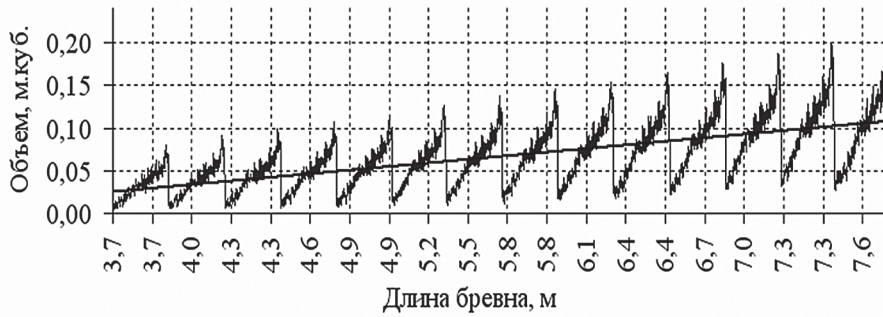
Рис. 5. Зависимость объема короткомерного сырья и отрезков досок ( m^3 ) от длины и диаметра бревна при сложной его ориентации перед раскромом и ширине пропилов первого и второго проходов 2,5 мм
