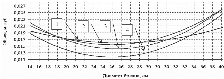
Рис. 2. Зависимость объема горбыля ( m^3 ) от вершинного диаметра бревна при ориентации \{x = 0,35; y = -0,35\} , при ширине пропилов первого и второго проходов 2,5 мм и длине бревна: 1 – 4,0 метра; 2 – 5,5 метра; 3 – 6,4 метра; 4 – 7,6 метра
