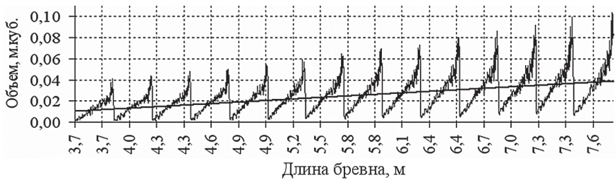
Рис. 3. Зависимость объемов рейки ( m^3 ) от вершинного диаметра бревна при ориентации \{x = 0,35; y = -0,35\} и ширине пропилов первого и второго проходов 2,5 мм
