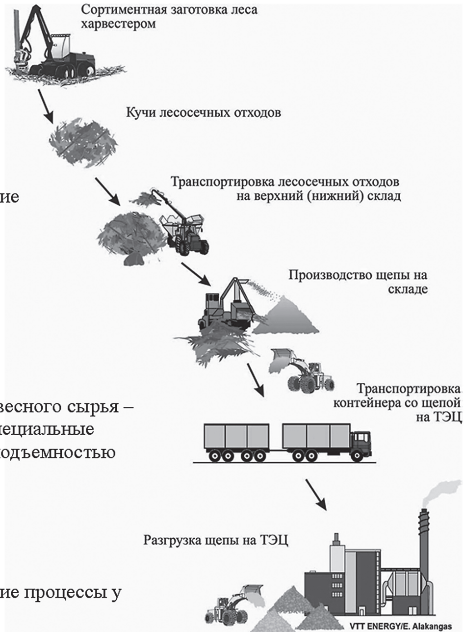
Рис. 1. Технология производства щепы на верхнем складе
