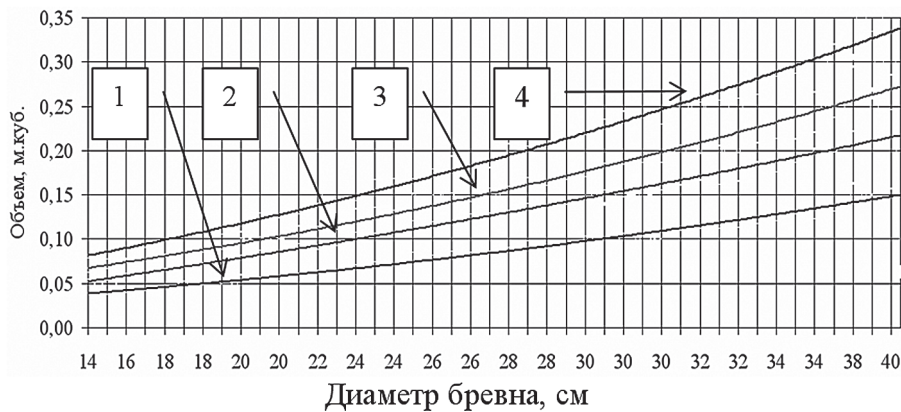
Рис. 6. Изменение объема древесных отходов, ( m^3 ), от диаметров торцов бревен, перерабатываемых при осевом способе, ширине пропилов 2,9 мм при длине пиловочника: 1 – 4,0 м; 2 – 5,5 м; 3 – 6,4 м; 4 – 7,6 м
