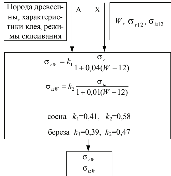
Рис. 3. Модели расчета прочности соединений по длине на растяжение и изгиб
