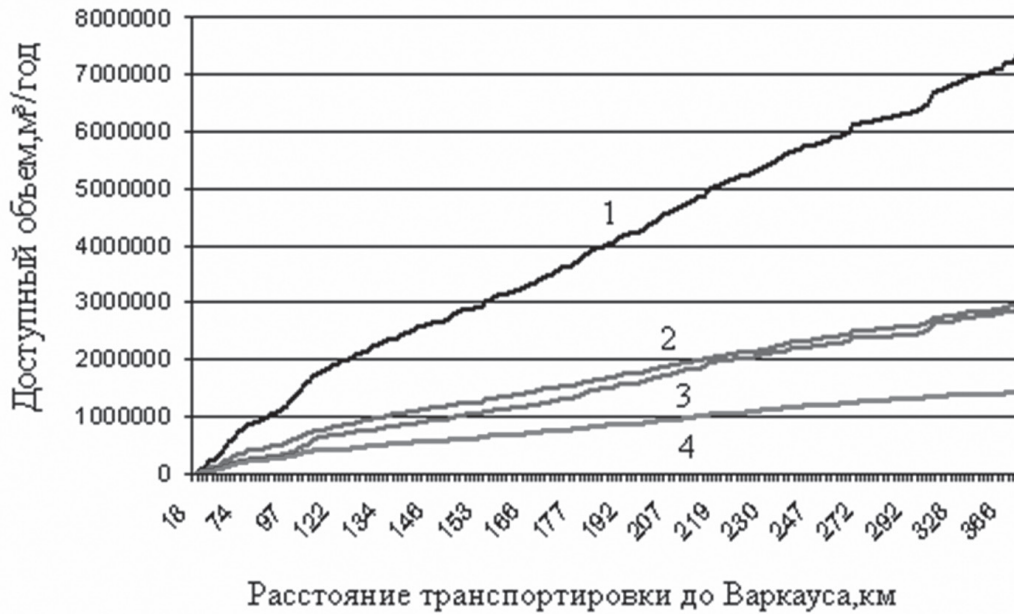
Рис. 1. Годовой объем доступной древесной щепы в зависимости от расстояния транспортировки [13]: 1 – общий; 2 – лесосечные отходы; 3 – неликвидная древесина; 4 – еловые пни
