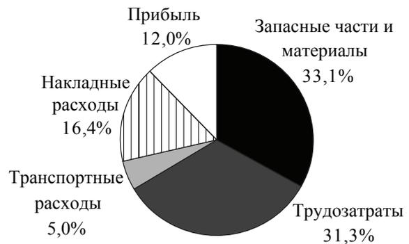
Рис. 2. Структура затрат на текущий ремонт тракторов ТТ-4М при минимуме простоев
