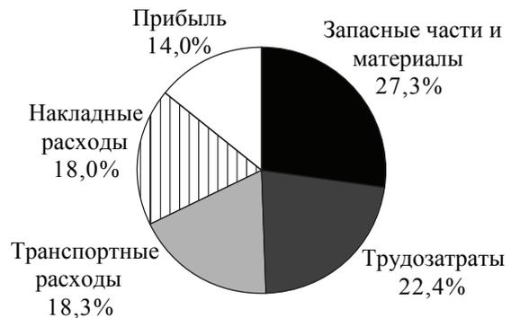
Рис. 1. Структура затрат на техническое обслуживание тракторов ТТ-4М при минимуме простоев
