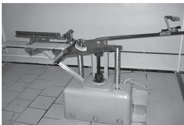
Рис. 2. Установка для гнутья на разный радиус кривизны
