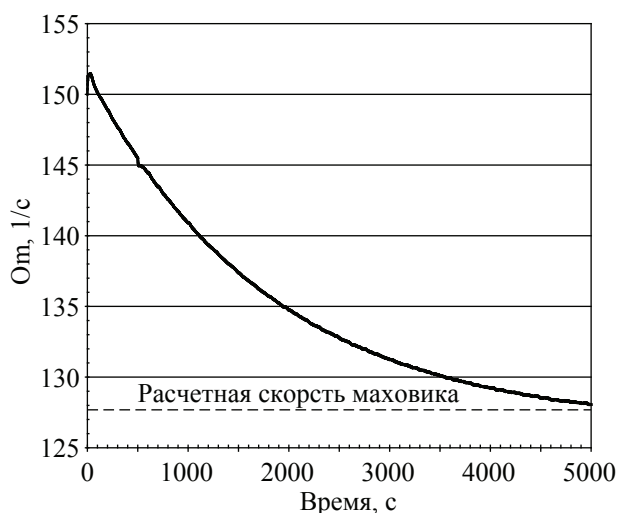
Рисунок. Изменение скорости вращения маховика при перераспределении скоростей ДМ
