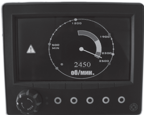
Рис. 5. Отображение текущего значения оборотов двигателя, полученного по CAN-bus (в режиме диагностики)
