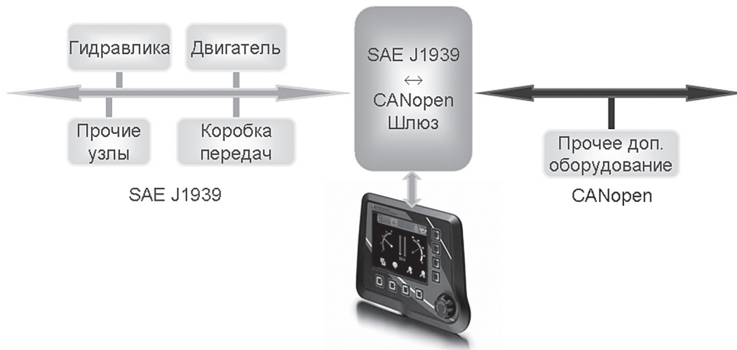
Рис. 3. Пример подключения аппаратно-программного комплекса визуализации информации оператора для современных бортовых систем управления транспортных средств и спец-техники
