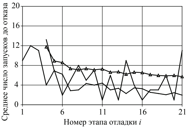
Рис. 2. Изменение надежности ПО в процессе отладки для различных моделей (до 21-го этапа отладки)
