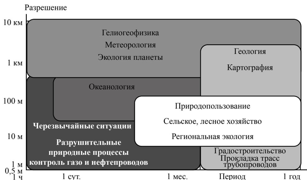
Рисунок. Основные требования потребителей к многофункциональной космической системе с микроспутниками ДЗЗ «Союз-Сат-О»
