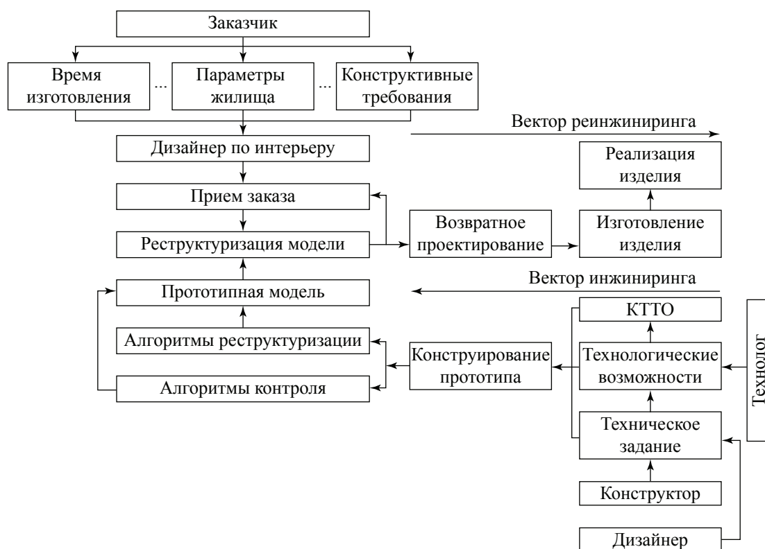
Рис. 2. Этапы инжиниринга и реинжиниринга в общей структуре процесса проектирования изделий корпусной мебели
