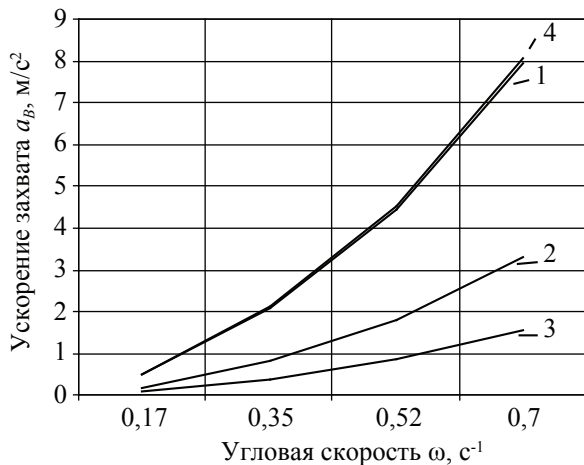
Рис. 4. Ускорения захвата при начальных углах \varphi = 60^\circ , \psi = 180^\circ и линейной скорости U = 0,2 м/с: 1 – стрела и рукоять вращаются и не выдвигаются; 2 – стрела вращается, рукоять выдвигается и не вращается; 3 – стрела неподвижна, рукоять вращается; 4 – стрела вращается, рукоять вращается и выдвигается.
