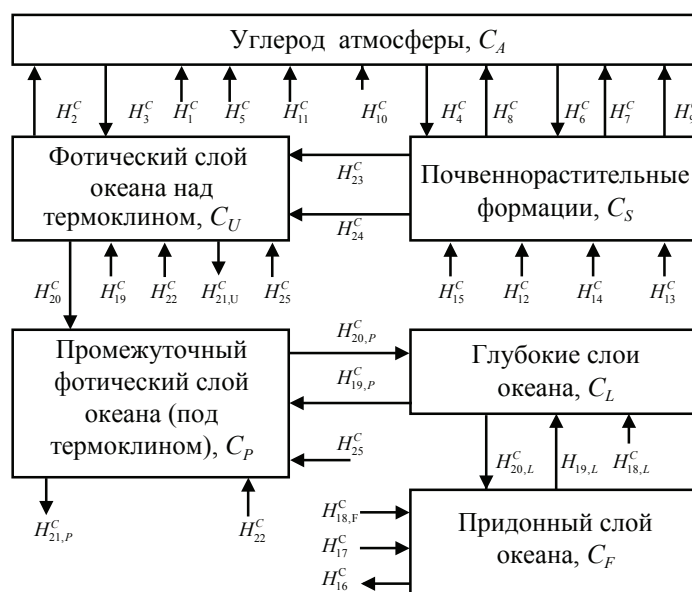
Рис. 2. Блок-схема глобального биогеохимического круговорота углекислого газа в системе атмосфера-суша-океан. Описание резервуаров и потоков CO 2 дается в табл. 5
