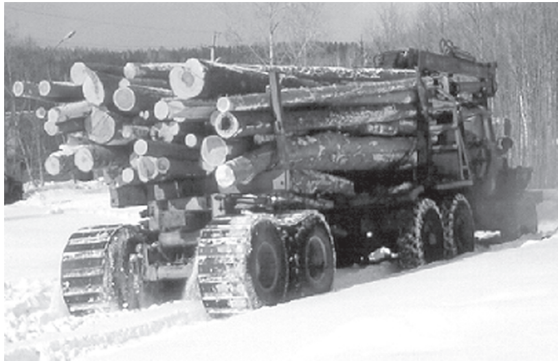
Рис. 1. Экспериментальный сортиментовоз повышенной проходимости на гибких резинометаллических гусеницах
