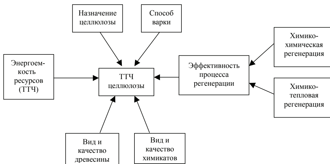
Рис. 3. Блок-схема основных факторов, влияющих на ТТЧ производства целлюлозы
