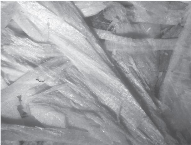
Рис. 2. Распределение стрендов во внутреннем слое плиты ( $\times 12$ )
