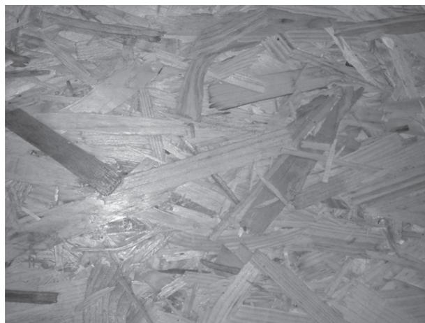
Рис. 1. Характер распределения стрендов в наружном слое плиты
