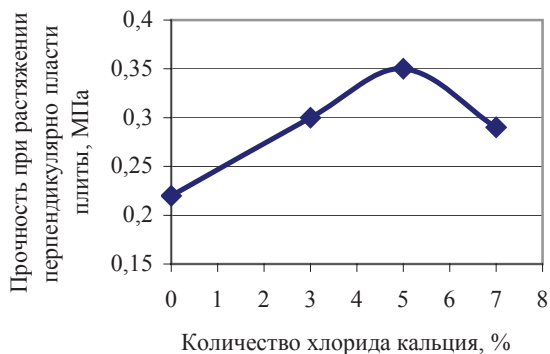
Рис. 7. Влияние количества хлорида кальция на прочность при растяжении к пласти плиты ЦСП
