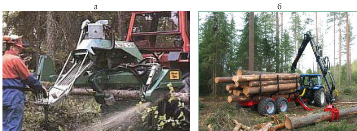
Рис. 1. Машины для малообъемных рубок: а) навесной процессор NIAB-5-15; б) сельскохозяйственный колесный трактор и лесовозный прицеп
