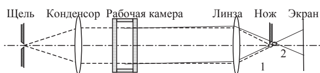
Рис. 3. Схема теневого прибора Теплера: 1 – фокус неискаженного светового пучка, 2 – фокус измерительного светового пучка
