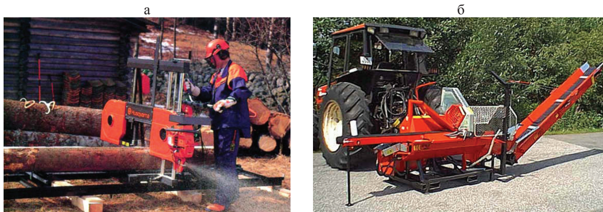
Рис. 2. Оборудование для переработки круглых лесоматериалов: а) передвижная лесопильная установка; б) навесной процессор для получения колотых дров
