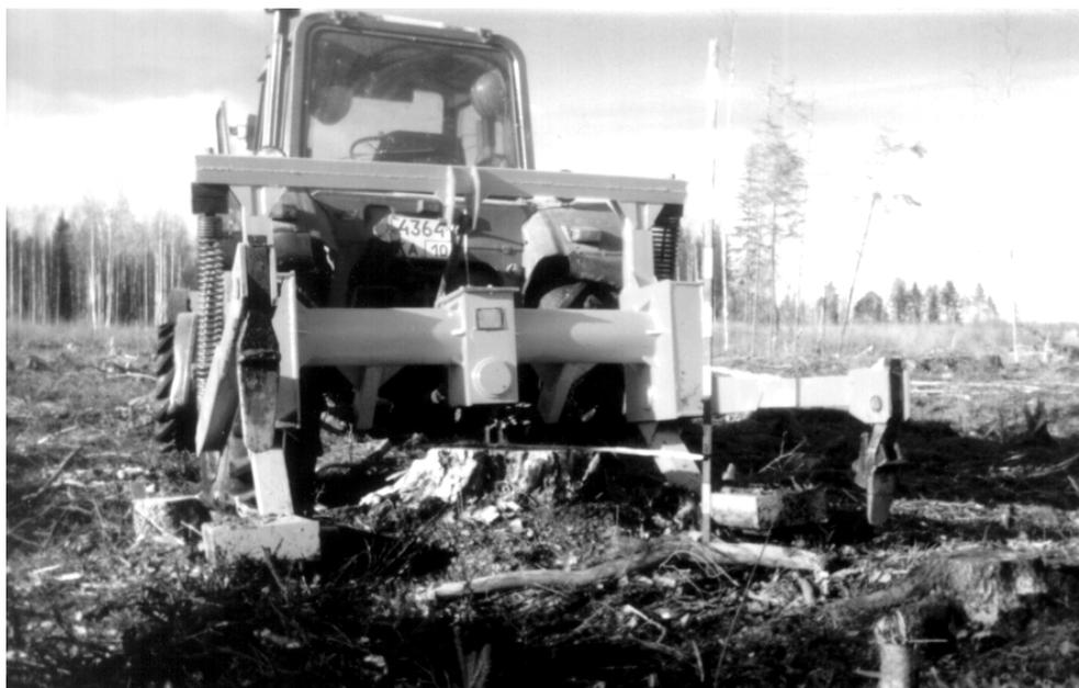
Рис. 3. Лункообразователь Л-2У в агрегате с трактором МТЗ-82
