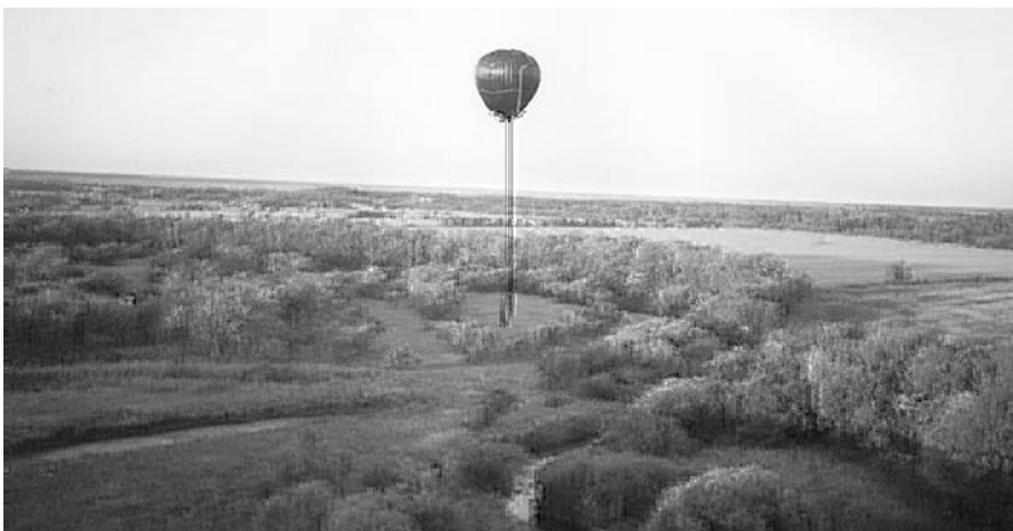
Поэтому в течение двадцати с лишним лет аэростатная система не претерпевала никаких изменений и, как обычно, представляла собой аэростат луковичного типа, сделанный из прорезиненной хлопчатобумажной ткани с алюминиевым напылением, стальной трособлочной системой, которая приводилась в движение мощными (до 600 л.с.) дизельными лебедками.
