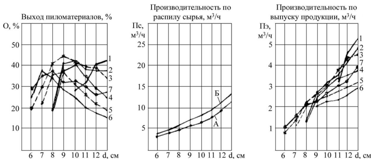
Рис. 4. Показатели обработки тонкомерного сырья диаметром 6–12 см при выпилке различной продукции: 1 – традиционные экспортные пиломатериалы 38,44 × 100 мм; 2 – экспортные пиломатериалы арабского рынка 66 × 66 мм с боковыми досками; 3 – заготовки для оконных блоков 50 × 65 мм с боковыми досками; 4 – бруски 66 × 66 мм для арабского рынка; 5 – заготовки для оконных блоков 50 × 65 мм; 6 – бруски 50 × 50 мм; 7 – заготовки 19 × 50 мм для паркета
