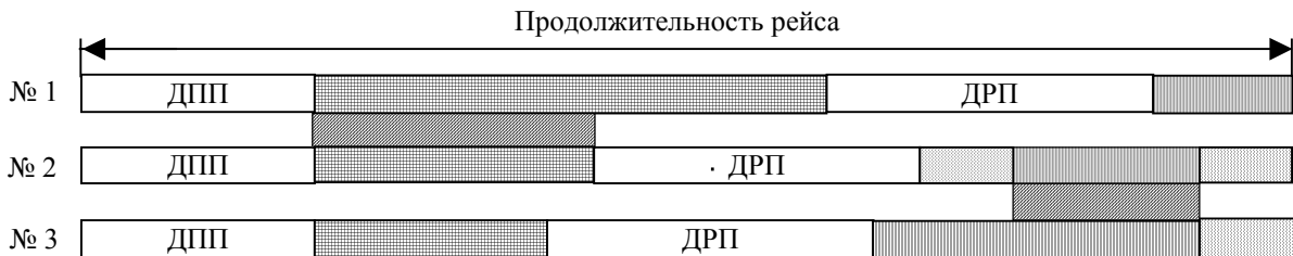
Рис. 1. Временная диаграмма работы звена автопоездов (первый способ): ДПП, ДРП – движение на погрузочный и разгрузочный пункты соответственно; [затененная область] – пребывание автопоездов под погрузкой и разгрузкой соответственно; [пустой промежуток] – простои в ожидании погрузки или разгрузки; [затененная область] – совместная работа автопоездов
