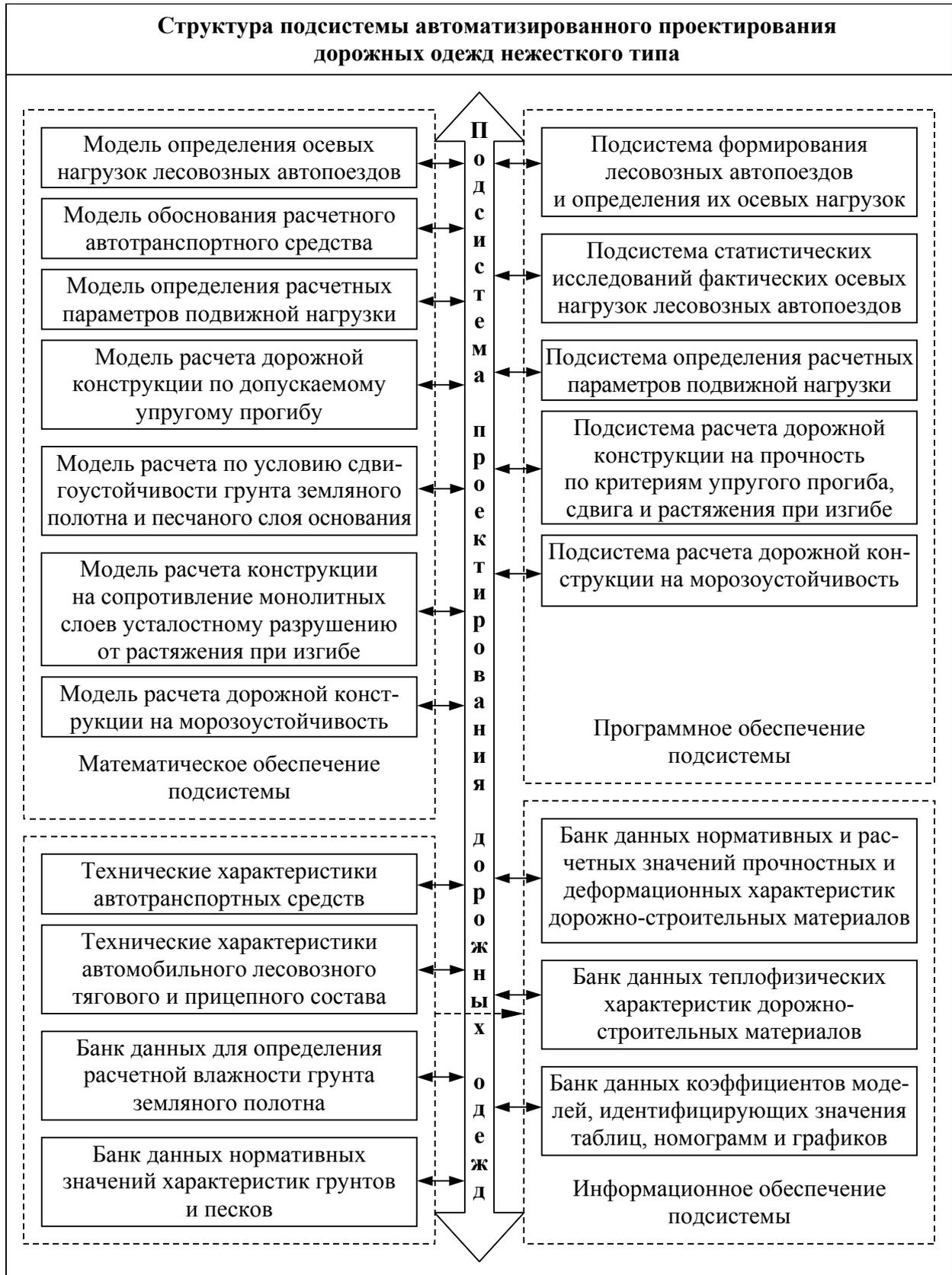
Рис. 2. Структура подсистемы автоматизированного проектирования дорожных одежд нежесткого типа
