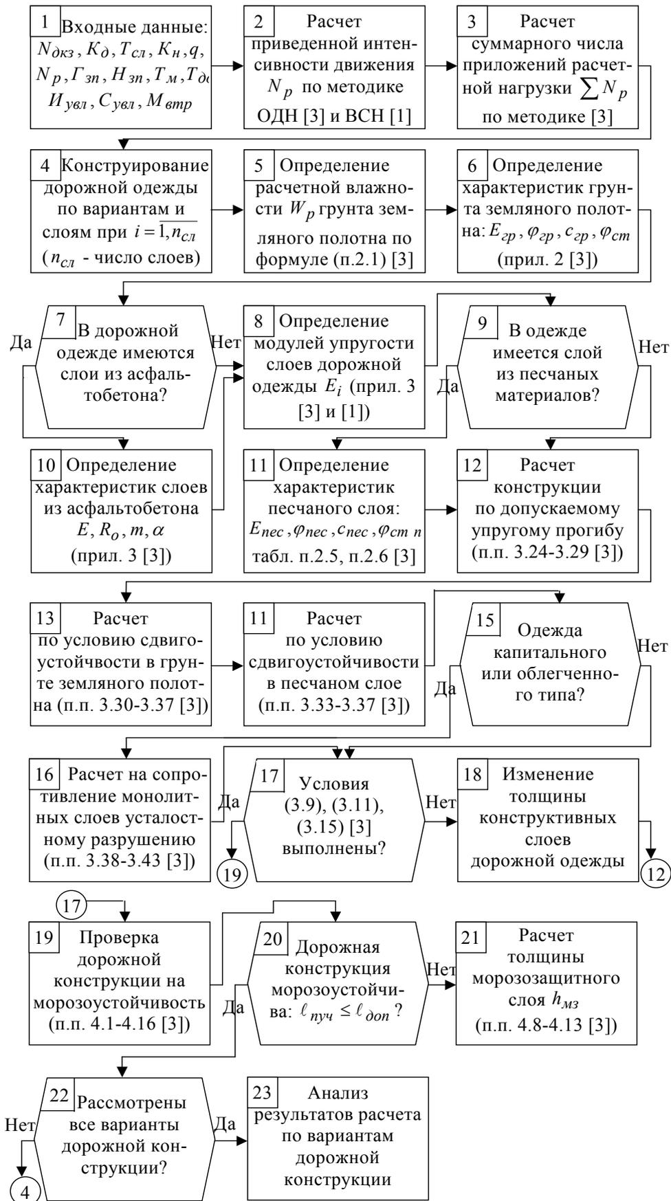
Рис. 1. Алгоритм расчета дорожных одежд нежесткого типа на прочность и морозоустойчивость
