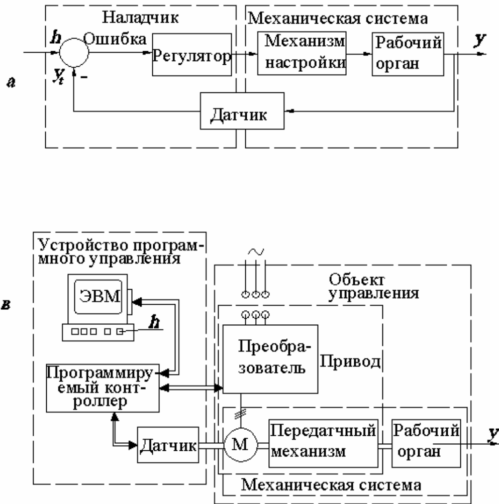
Рис. 2. Функциональная схема системы с управлением: а – ручным; б – числовым программным с помощью ЭВМ
