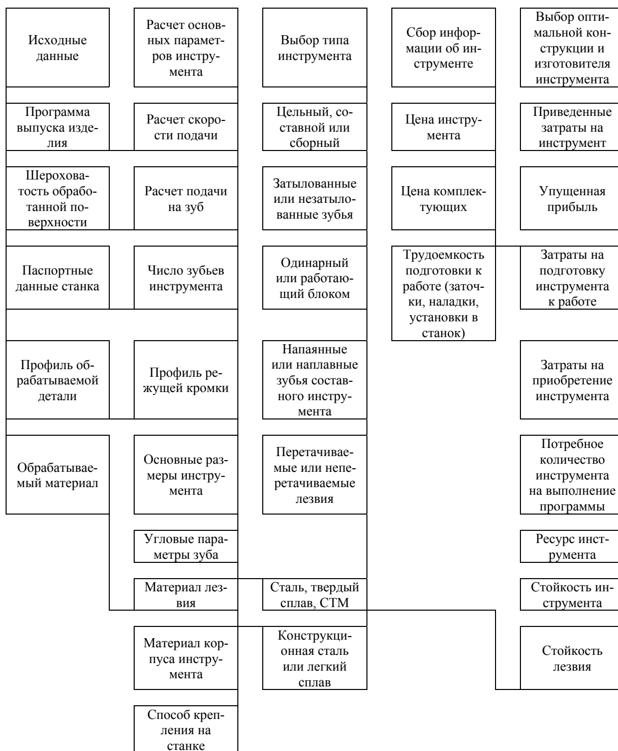
Рис. 2. Алгоритм определения основных параметров инструмента, выбора его конструктивного решения и изготовителя
