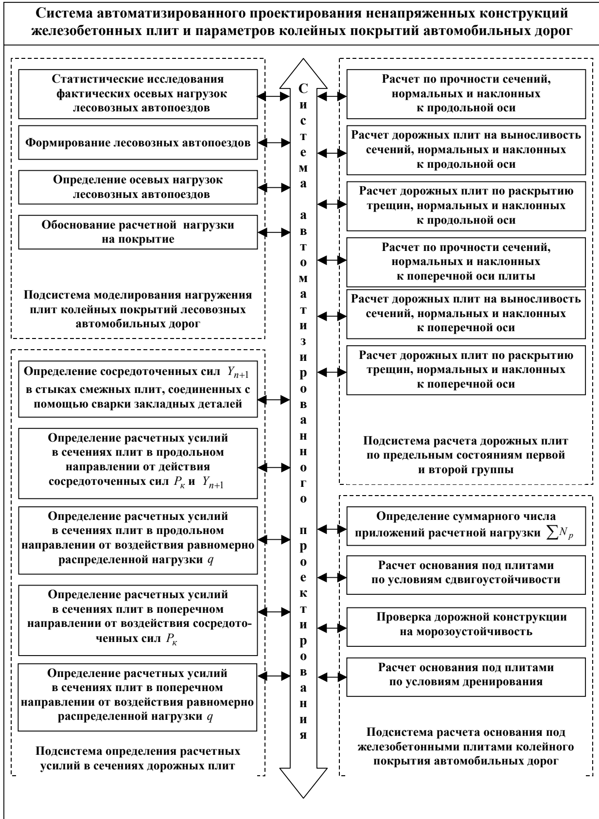
Рис. 1. Схема САПР ненапряженных конструкций железобетонных плит и параметров колеиных покрытий автомобильных дорог
