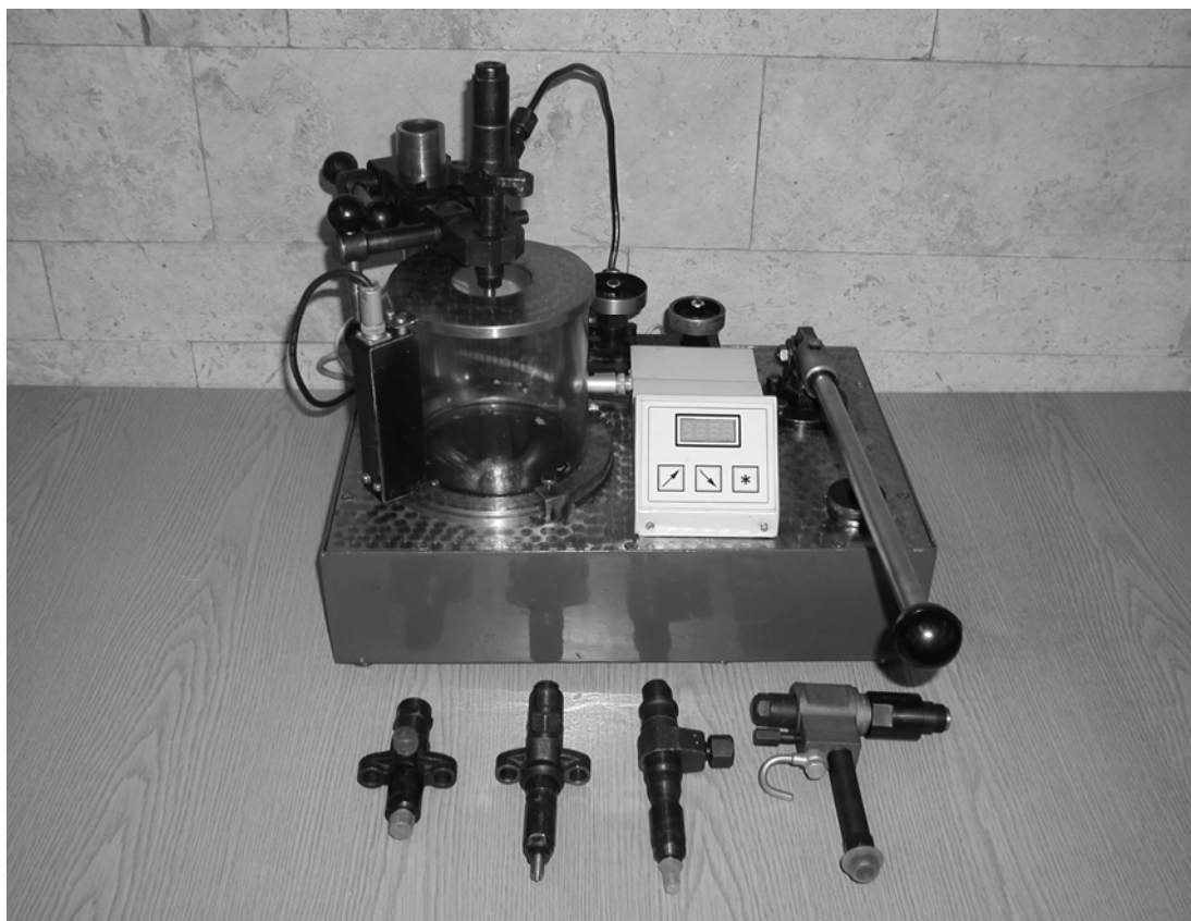
Рис. 2. Общий вид модернизированного прибора для испытания и регулирования форсунок КИ-35435
